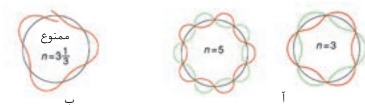
شکل ۳۴. مدارهای که محیط آن با مضرب صحیحی از طول موج برابر است. (ب) مدارهای که محیط آن مضرب صحیحی از طول موج نیست و در نتیجه، فاصله موج الکترون از آن یکنواخت نیست. چنین مدار غیرمجاز است.
