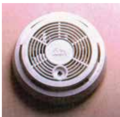
شکل ۵۰- آشکارسازهای دود شامل یک چشمه آمريسيوم هستند. ذره‌های دود تابش آلفا را متوقف می‌کنند و زنگ به‌کار می‌افتد.
