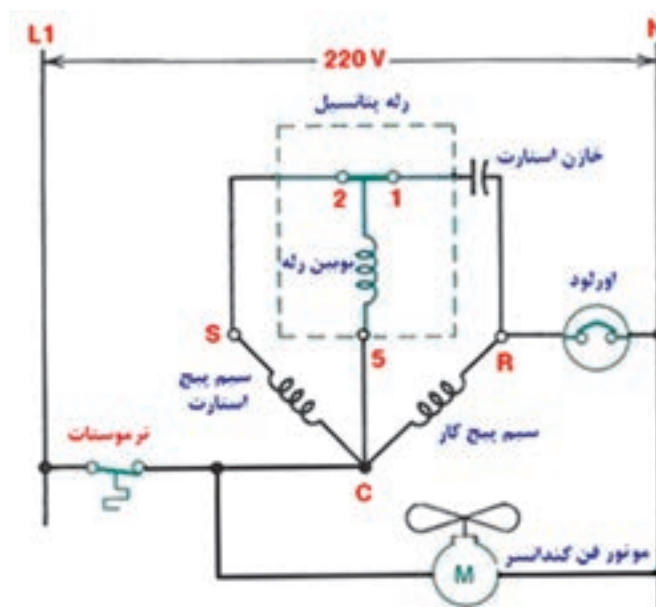
شکل ۱۸-۱۰- مدار الکتریکی آب سردکن
