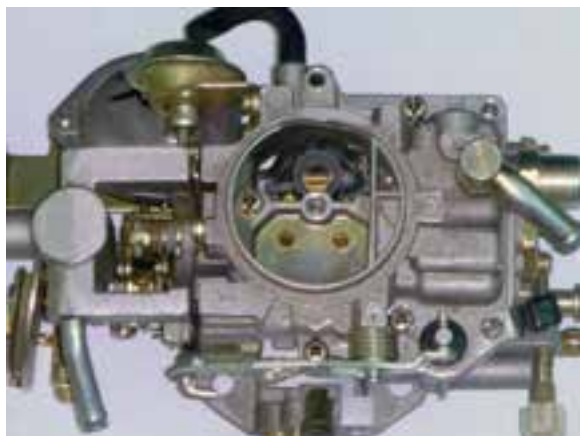
شکل ۱-۸۱ دریچه ساسات در کاربراتور دودخانه با راه‌انداز حرارتی
