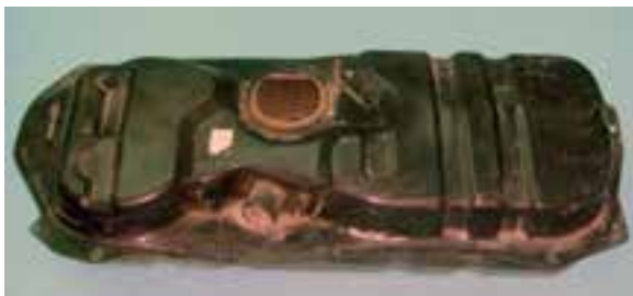
شکل ۱-۲۶ مخزن سوخت آماده نصب
