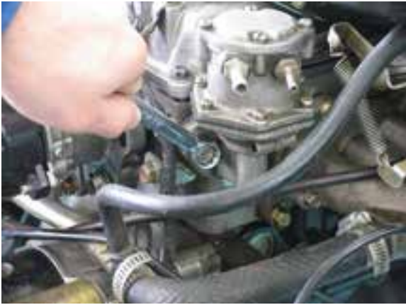
شکل ۱-۴۲ پیاده کردن پمپ
