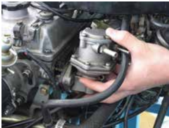
شکل ۱-۴۴ الف: نصب پمپ
