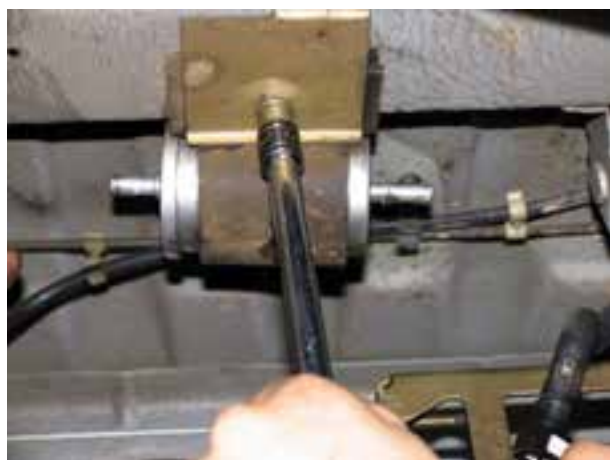
شکل ۱-۴۸ نصب فیلتر جدید
