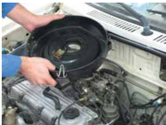
شکل ۱۱۴- ۱ پیاده کردن مجموعه هواکش
