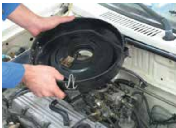
شکل ۱۰۰-۱ پیاده کردن مجموعه هواکش
