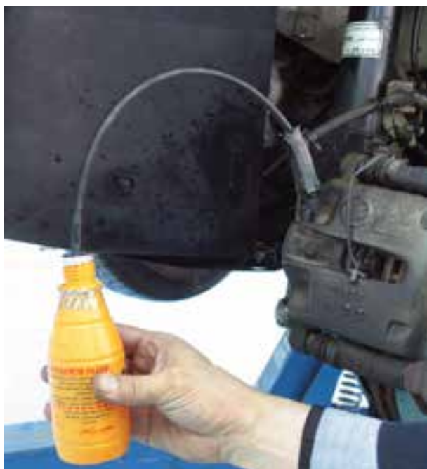
شکل ۱-۷۱- نصب لوله پلاستیکی روی پیچ هواگیری
