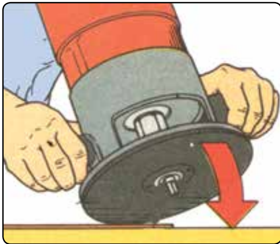
شکل ۲-۵۱ شروع فرز کاری در روی سطح کار بایستی مطابق شکل و به آرامی انجام شود
