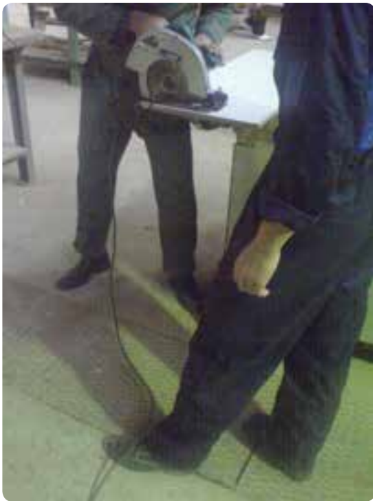
شکل ۲۷-۲ سیم سیار در مسیر نباشد
