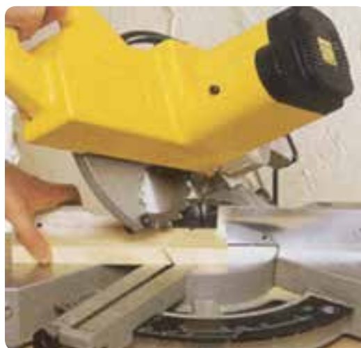
شکل ۱۴-۲- برش تحت زاویه
