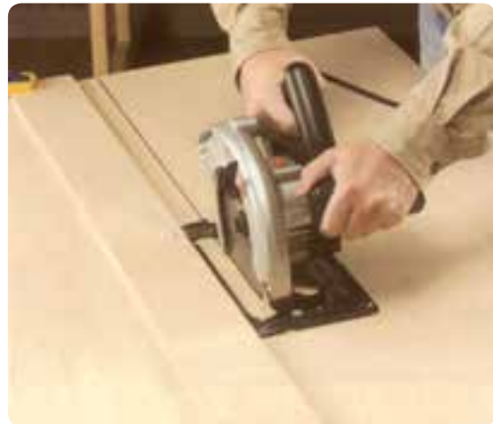
شکل ۲۳- برش طولی با گونیای برراستی
