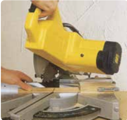
شکل ۲-۱۲- برش قائم با اره گرد فارسی بر
