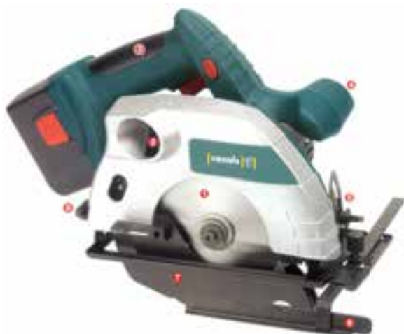
شکل ۲۱-۲ تنظیمات ماشین اره گرد دستی برقی
