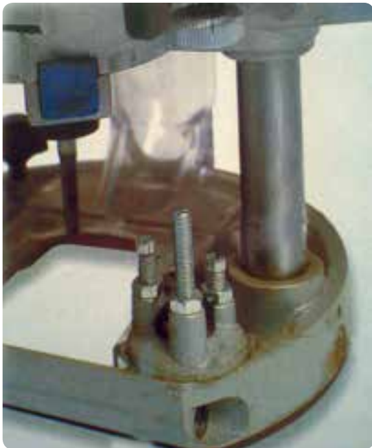
شکل ۴۴-۲ پیچ‌های تنظیم ارتفاع اور فرز دستی برقی
