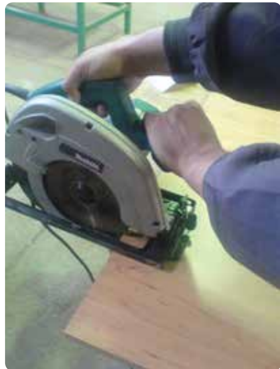
شکل ۲۹-۲ بیانگر رعایت نکردن اصول ایمنی در بکارگیری دستگاه که عامل بروز حادثه است
