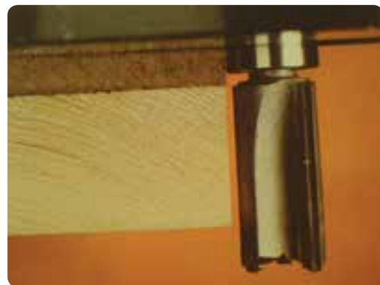
شکل ۲-۵۰ بلبرینگ قبل از تیغه فرز نصب شده است
