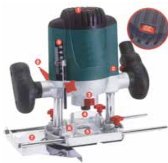
شکل ۲-۳۹ قسمت‌های مختلف ماشین اور فرز دستی برقی
