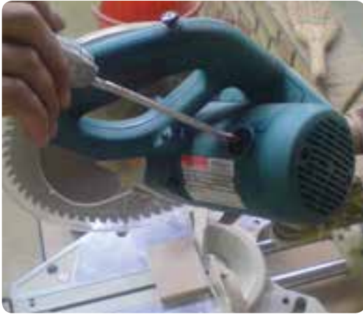
شکل ۱۷-۲ - بازدید زغال کلکتور الکترو موتور در ماشین اره گرد فارسی بر
