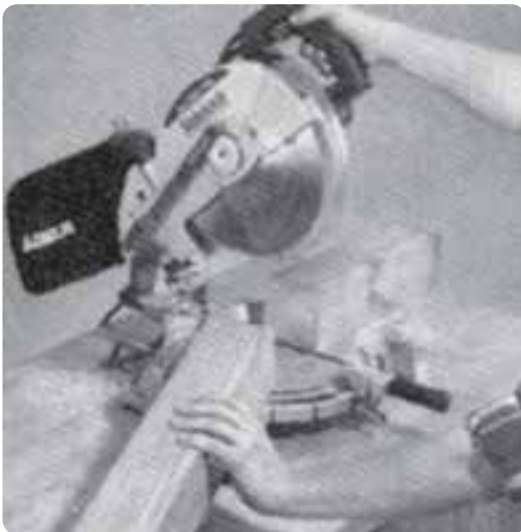
شکل ۲-۱۳- برش تحت زاویه
