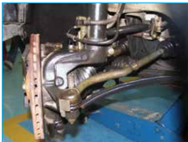
شکل ۱-۱۱۸- باز کردن مهره لوله ترمز
