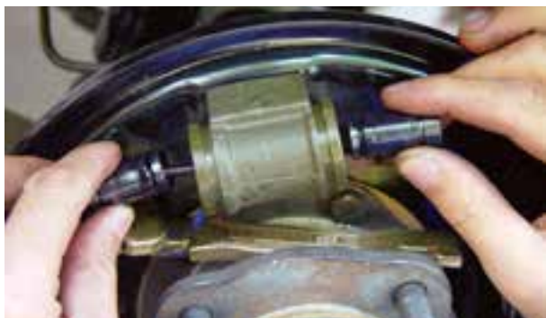
شکل ۹۴-۱- خارج کردن پیستون‌ها
