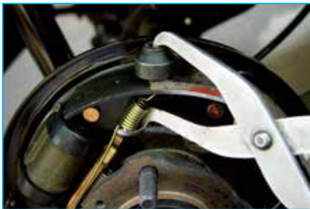
شکل ۹۱-۱- خارج کردن فنر بالایی
