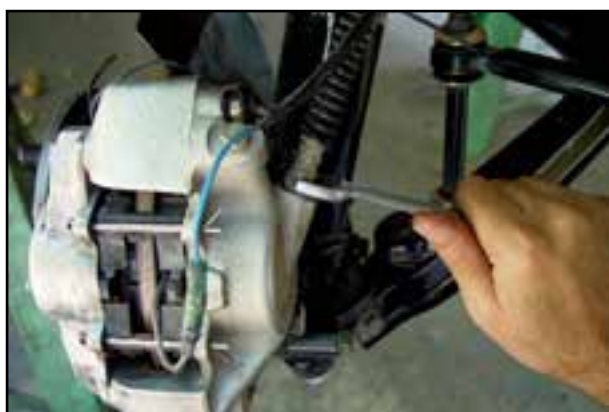
شکل ۱-۱۱۹- باز کردن شیلنگ ترمز
