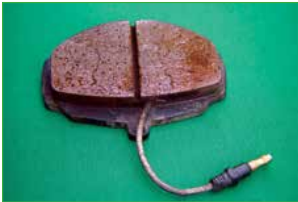
شکل ۱۱۲-۱- لنت ترمز دارای سیم هشدار
