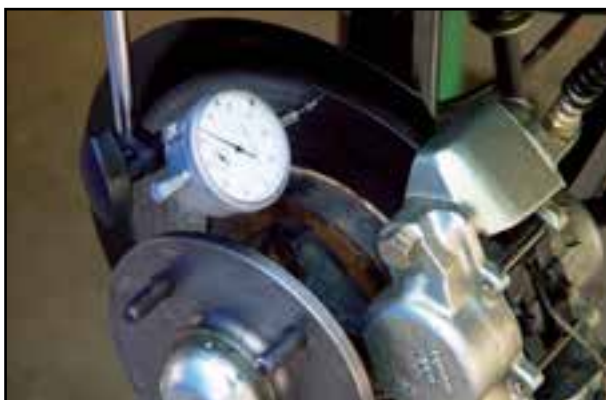
شکل ۱-۱۲۳- بررسی وضعیت دیسک
