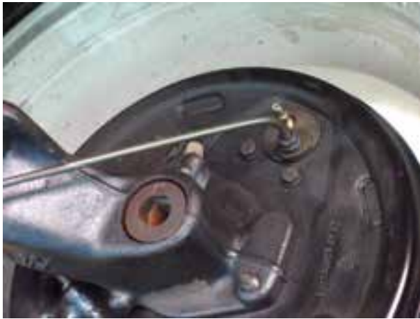
شکل ۱۰۳-۱- پاک کردن اطراف اتصالات
