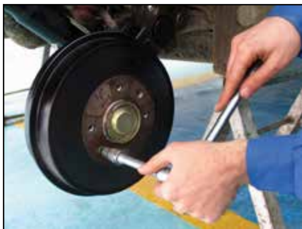
شکل ۱-۱۰۲- بستن بیج نگه‌دارنده کاسه چرخ
