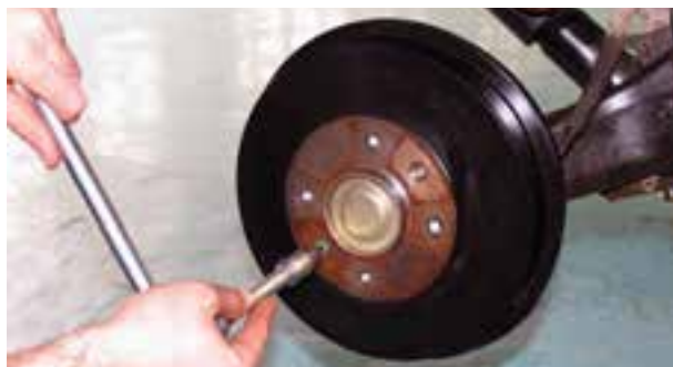
شکل ۱-۸۹ – باز کردن پیچ کاسه چرخ
