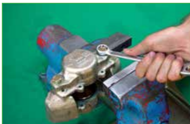
شکل ۱-۱۲۰- باز کردن پیچ های کالیپر
