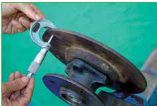
شکل ۱-۱۲۴- اندازه‌گیری ضخامت دیسک
