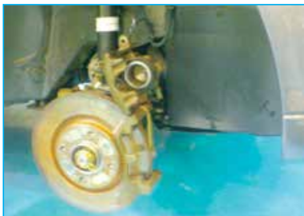
شکل ۱۱۰-۱- باز کردن پوسته نگه دارنده لنت‌ها
