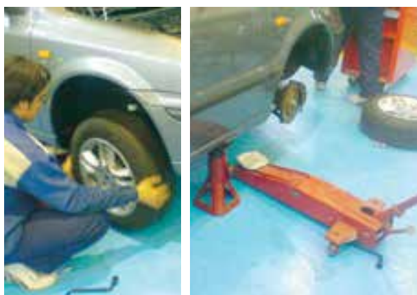
شکل ۱-۱۱۷-۱- بالا بردن و پیاده کردن چرخ جلو
