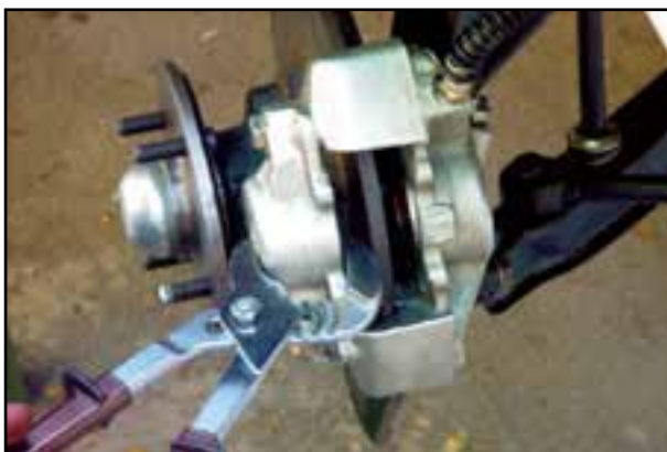
شکل ۱۱۴-۱- عقب راندن پیستون ترمز دیسکی
