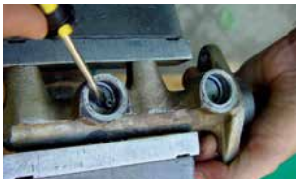
شکل ۱-۱۳۱- بستن سیلندر اصلی به گیره
