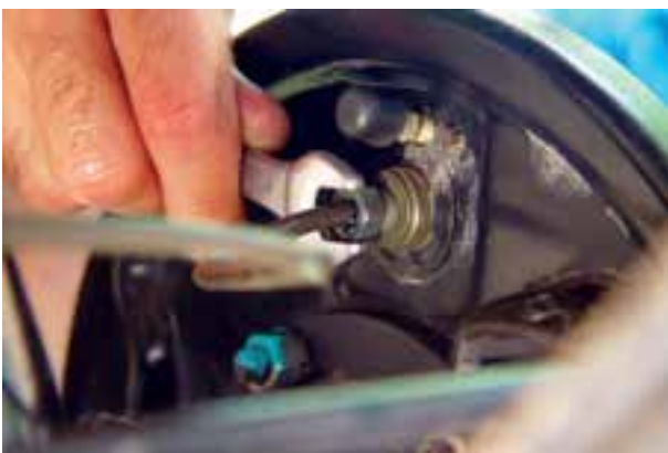
شکل ۱۰۵-۱- باز کردن مهره اتصال لوله ترمز
