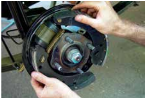
شکل ۱۰۴-۱- خارج کردن کفشک‌ها
