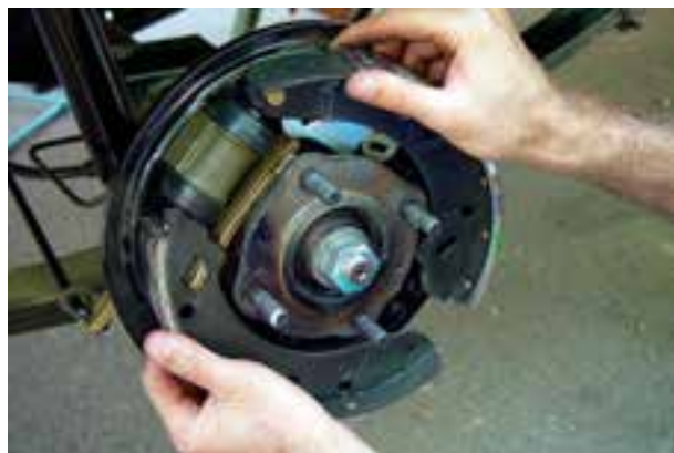
شکل ۹۳-۱- خارج کردن کفشک‌ها
