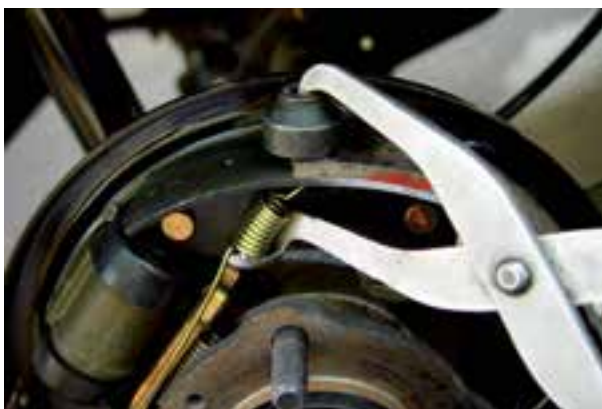
شکل ۱-۱۰۷- جازدن فنر بالایی کفشک
