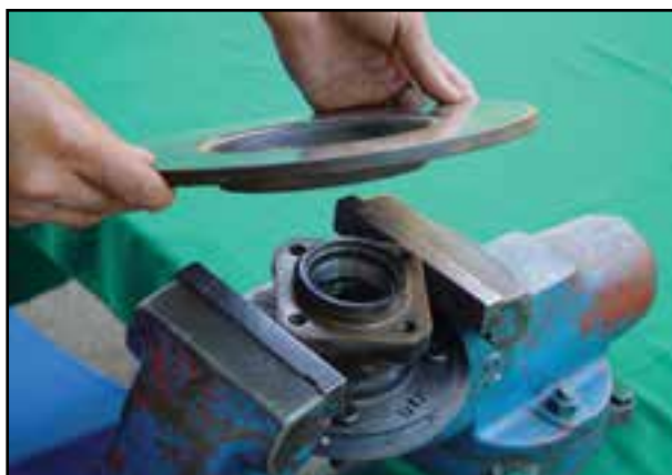
شکل ۱-۱۲۶- باز کردن دیسک ترمز
