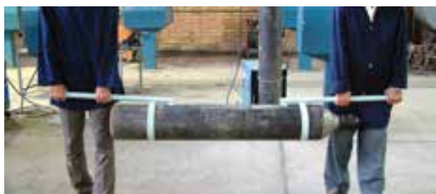
شکل ۸۶-۲- روش درست جابه‌جا کردن کپسول
