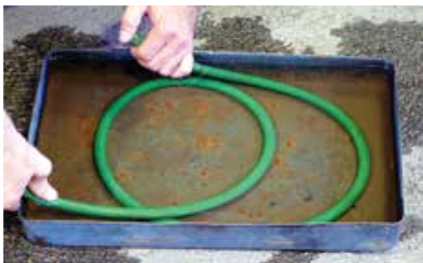
شکل ۲-۹۹ – کنترل نشتی شیلنگ در آب
