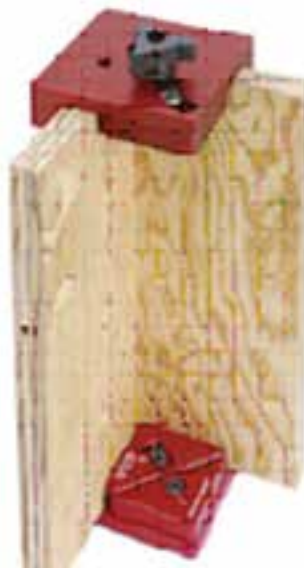
شکل ۳۶- مونتاز پانل‌های عمودی
