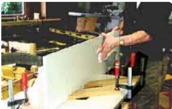
شکل ۳-۲۷ شانه‌های حفاظتی به صورت افقی
