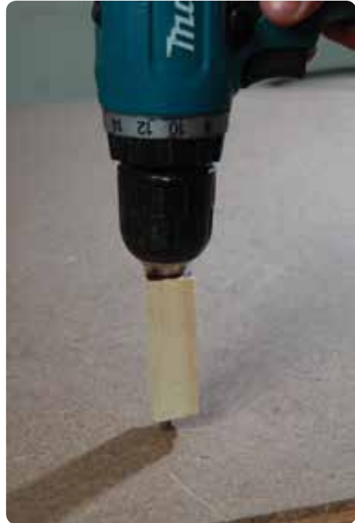
شکل ۳-۳۲ سوراخ دریل قطعه کنترل اندازه عمق
