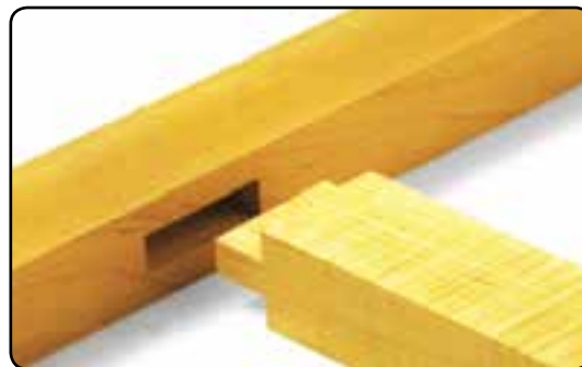
شکل ۳۶-۴ اتصال کُم و زبانه مخفی (یک طرفه)
