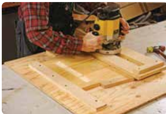
شکل ۳-۲۹ شابلون تسریع کننده و حفاظتی اورفرز
