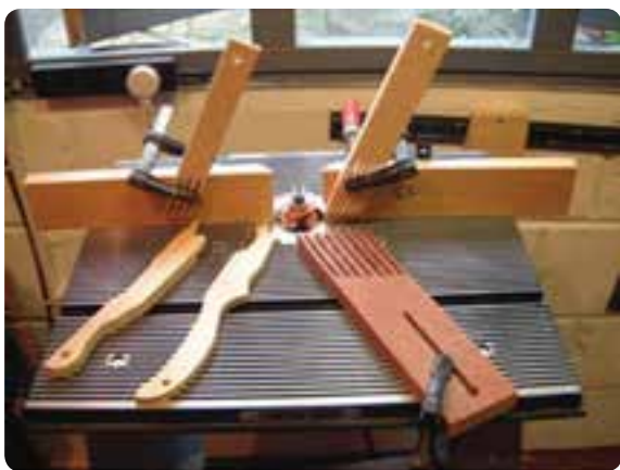
شکل ۳-۲۸ شانه‌های حفاظتی به صورت عمودی
