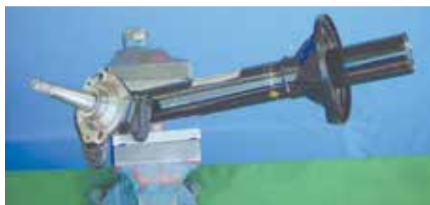
شکل ۳-۹۷- پوسته کمک فنر و محور چرخ
