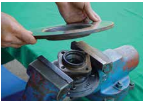
شکل ۳-۹۸- جدا کردن دیسک ترمز از تویی چرخ
