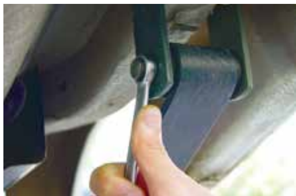
شکل ۳-۶۵ – باز کردن مهره‌های گوشواره فنر شمش
