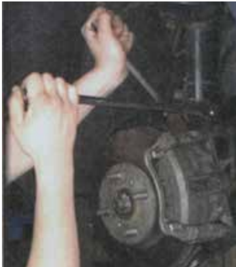
شکل ۳-۱۰۰ نصب مجموعه سیستم تعلیق روی خودرو
