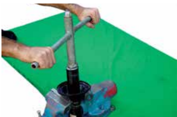
شکل ۳-۹۱- باز کردن مهره نگه‌دارنده کمک فنر
