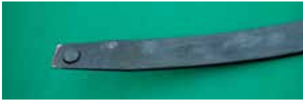
شکل ۷۰-۳- لاستیک‌های محافظ انتهایی لایه‌های فنر شمش
