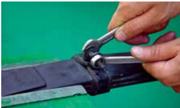
شکل ۳-۶۷- باز کردن بست‌های مجموعه فنر شمش
