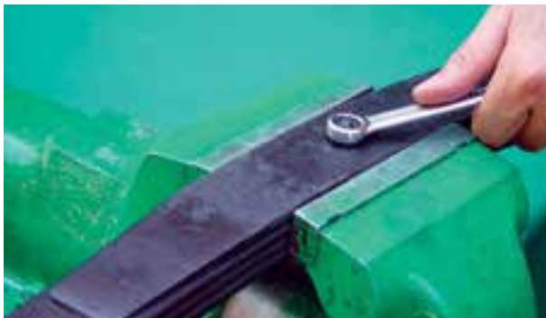
شکل ۳-۶۸- باز کردن پیچ مرکز فنرهای شمش
