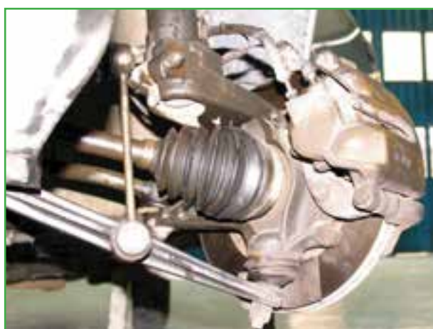
شکل ۳-۱۲۸- باز کردن پیچ‌های میل موج‌گیر
