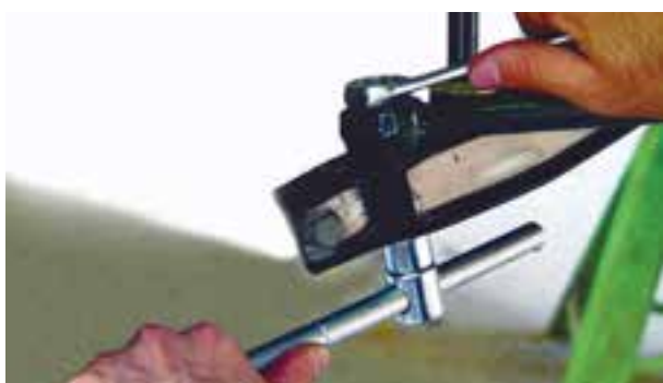
شکل ۳-۸۱ باز کردن میل تعادل از طبق
