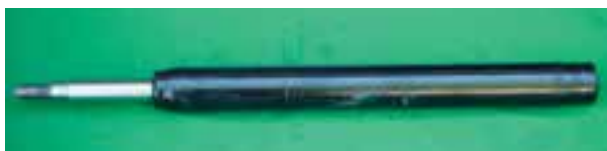
شکل ۳-۹۲- کمک فنر قابل تعویض
