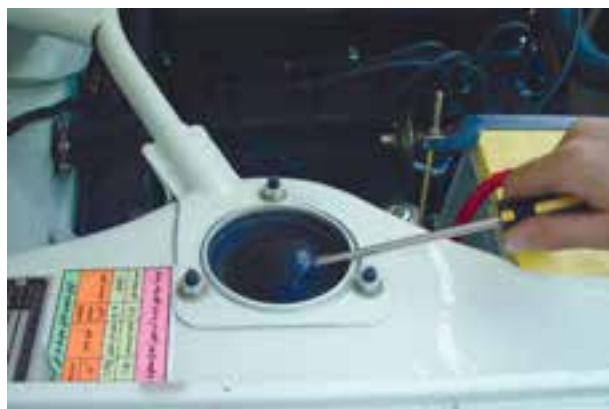
شکل ۳-۷۶- بیرون آوردن درپوش لاستیکی کمک فنر
