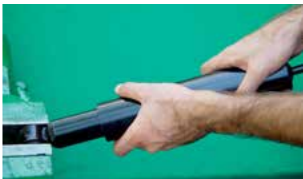
شکل ۳-۷۴- آزمایش کمک فنر
