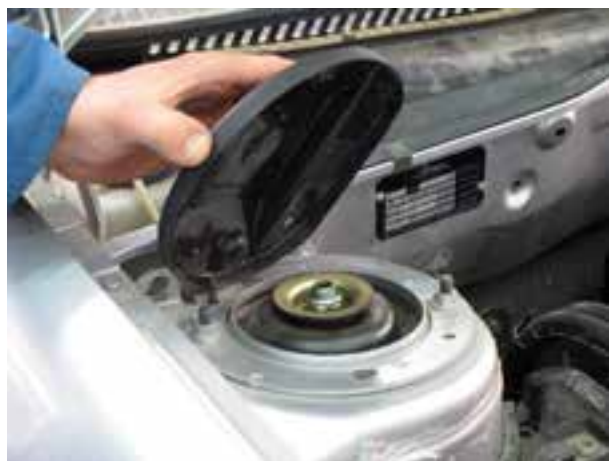
شکل ۳-۱۰۳ برداشتن پوشش بالای تکیه‌گاه کمک فنر
