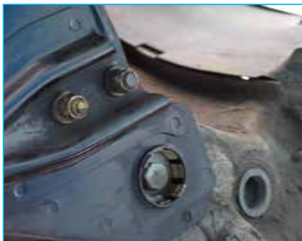
شکل ۳-۱۲۲- باز کردن پیچ های طبق
