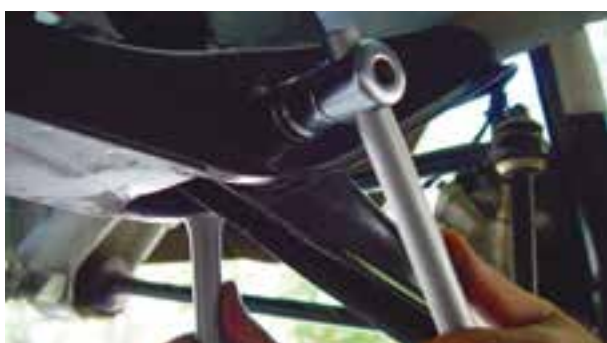
شکل ۳-۸۳- باز کردن طبق از رام
