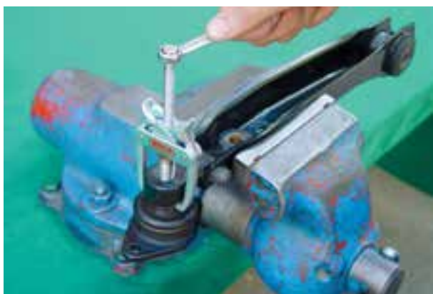
شکل ۳-۸۵- جدا کردن سیبک از بازوی اتصال
