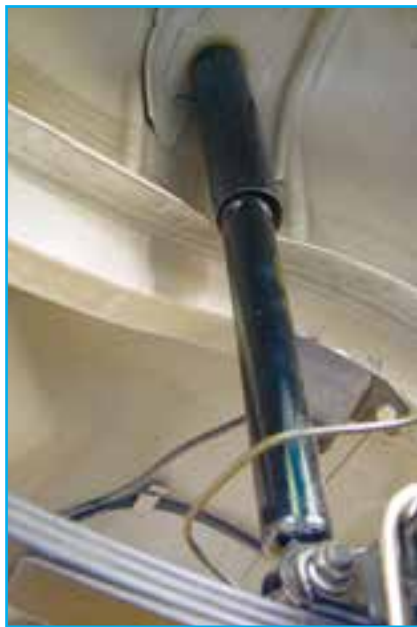
شکل ۳-۶۲- محل نصب کمک فنر روی سیستم تعلیق ثابت
