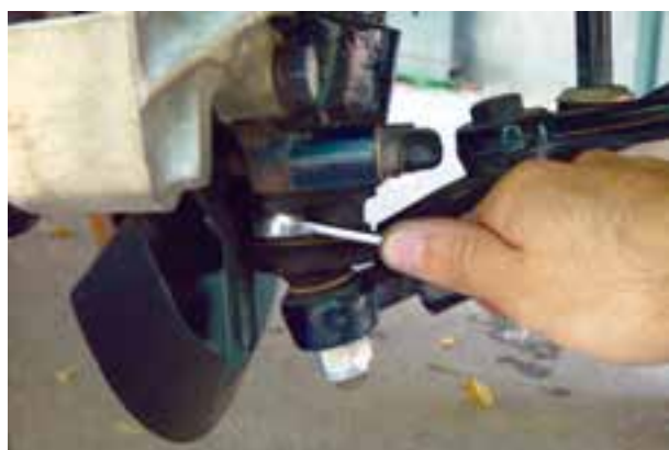
شکل ۳-۷۸- باز کردن سیبک زیر کمک فنر
