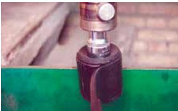
شکل ۳-۶۹- بوش لاستیکی فلزی محل اتصال شاه فنر
