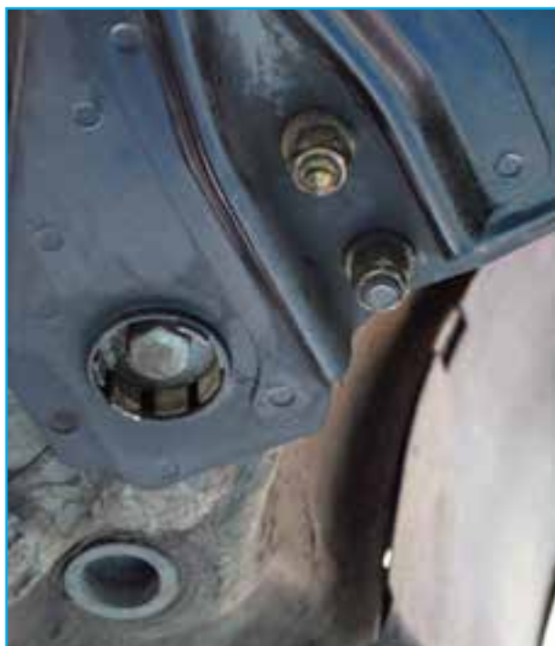
شکل ۱۳۰-۳- پیاده کردن میل موج گیر بلند
