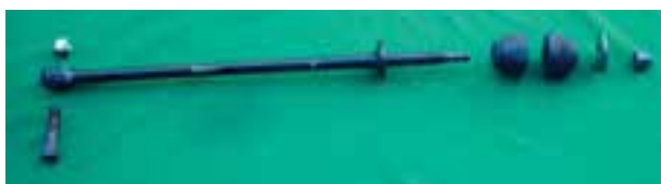
شکل ۳-۸۴- اجزای میل تعادل
