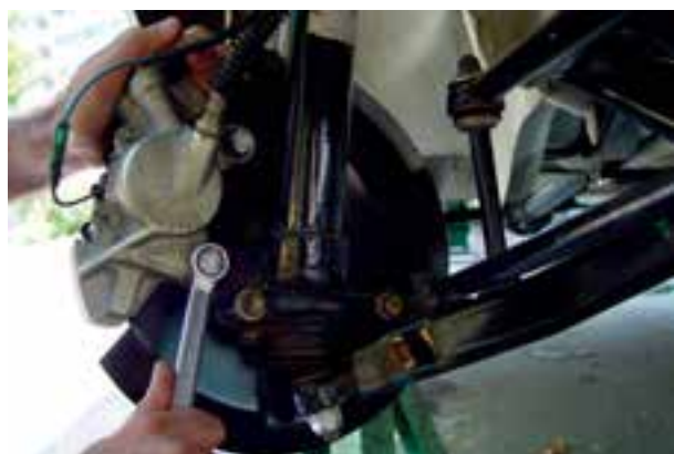
شکل ۳-۷۷- باز کردن کالیبر ترمز
