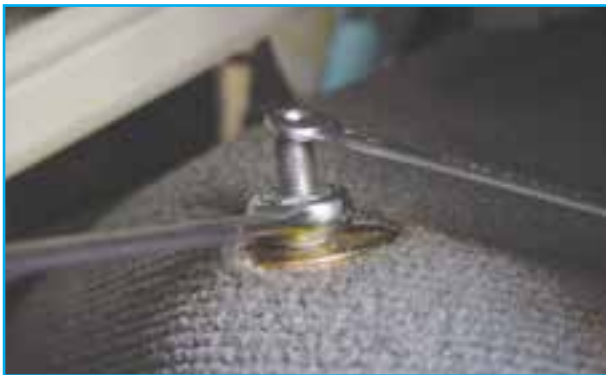
شکل ۳-۶۳- باز کردن مهره اتصال بالای کمک فنر
