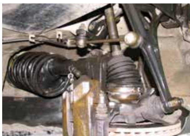
شکل ۱۳۱-۳- نصب میل موج گیر کوتاه
