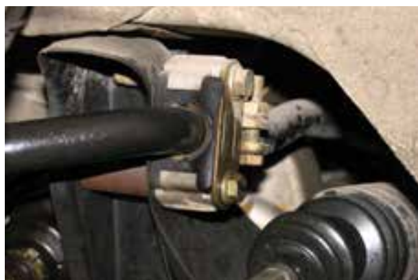
شکل ۱۳۲-۳- نصب بست‌های میل موج گیر بلند
