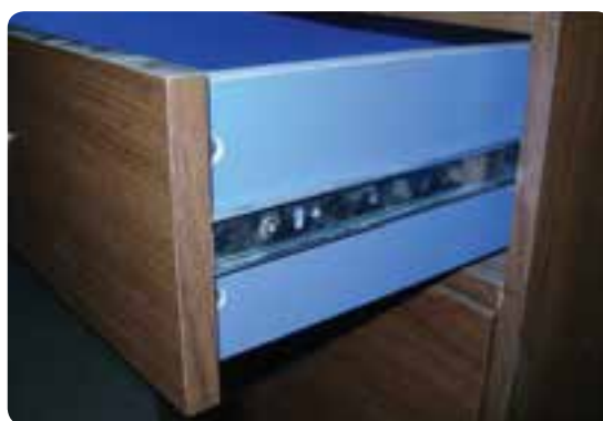
شکل ۵۶-۶ ریل مکانیکی نصب شده در بدنه جعبه
