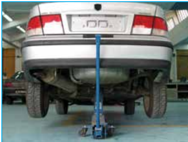
شکل ۳-۱۵۶- تنظیم ارتفاع و کنترل رام لوله‌ای
