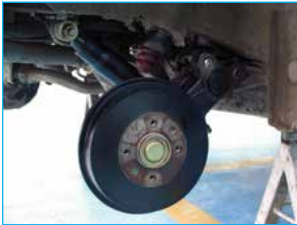
شکل ۱۸۳-۳- نصب ژامبون و متعلقات چرخ عقب
