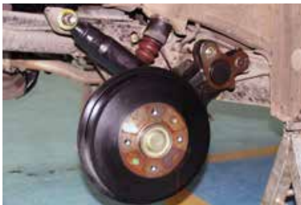
شکل ۱۷۷-۳- نصب کمک فنر
