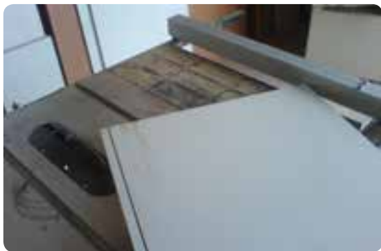
شکل ۶-۶۹- کنشکاف زدن جهت پشت بند
