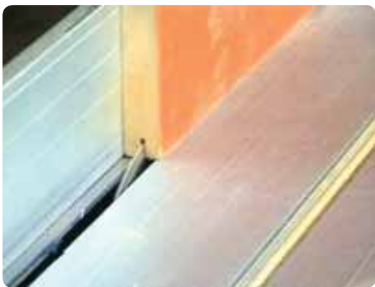
شکل ۶-۹۰ دو راهه کردن با ماشین اره مجموعه‌ای
