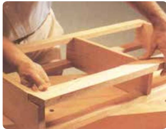
شکل ۶-۱۵۵ مونتاژ کلاف قاب دراور
