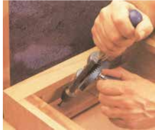
شکل ۱۶۱-۶ مونتاژ صفحه میز به قاب دراور
