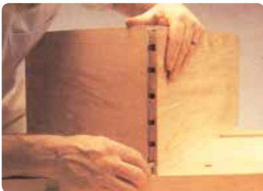
شکل ۶-۱۴۰ مونتاژ آزمایشی قبل از چسب زدن قطعات
