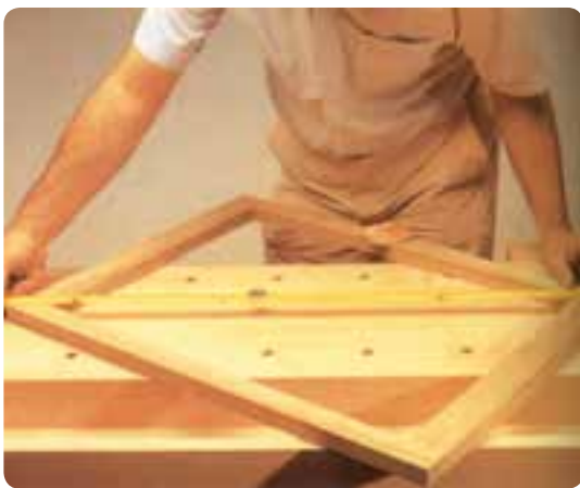
شکل ۱۵۰-۶ اطمینان از گونیایی قاب
