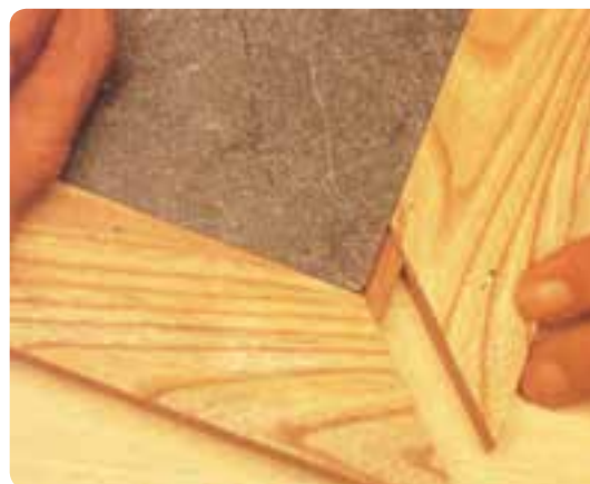
شکل ۶-۱۵۲ مونتاژ صفحه میز
