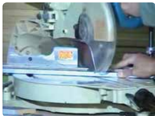
شکل ۶-۹۲ برش پروفیل‌ها با دستگاه فارسی بر
