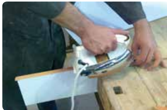
شکل ۶-۸۱ لبه چسبانی روکش مصنوعی با اتو
