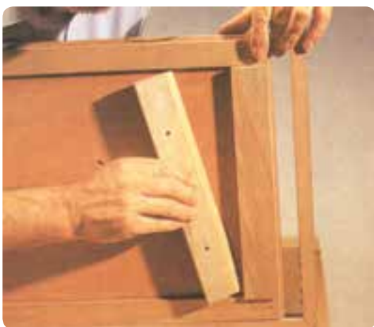
شکل ۱۴۴-۶ اتصال قید کمکی جهت نصب روی دیوار
