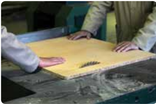
شکل ۶-۷۷ - برش در ساده کابینت
