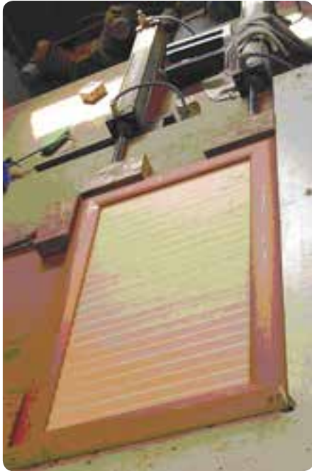
شکل ۶-۹۷ تنگ نیوماتیکی جهت مونتاژ در قابدار کابینت
