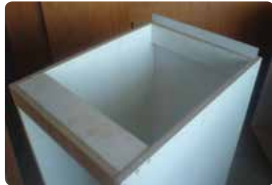
شکل ۶-۷۵ - مونتاژ کابینت با قرارگیری پشت‌بند
