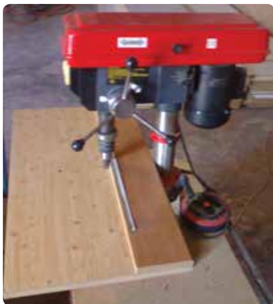
شکل ۶-۷۰- دریل ستونی همراه با شابلون جهت سوراخ‌کاری
