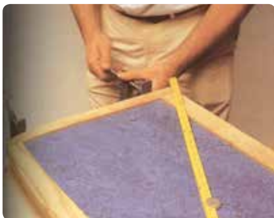
شکل ۶-۱۵۳ تنگ بستن صفحه میز
