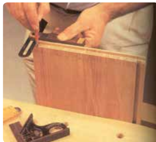
شکل ۶-۱۳۶ خط‌کشی اتصال دم‌چلچله دورو مخفی
