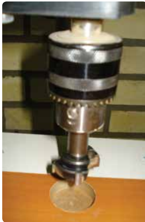
شکل ۶-۷۱ مته کابینت جهت سوراخ کردن جای لولا
