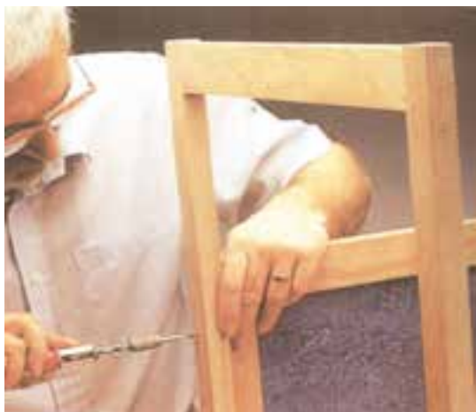
شکل ۶-۱۶۰ مونتاژ قاب پشت با قاب کناری
