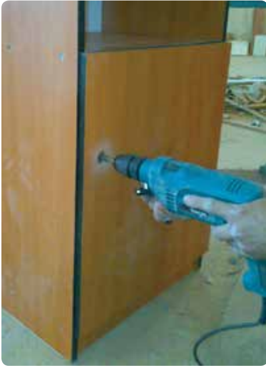
شکل ۱۲۳-۶ در آوردن جای قفل سوئیچی
