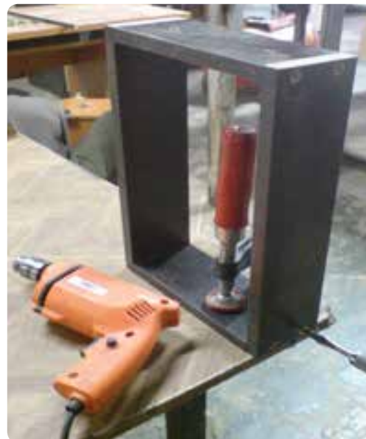
شکل ۶-۱۰۸ مونتاژ دستی جعبه کشو
