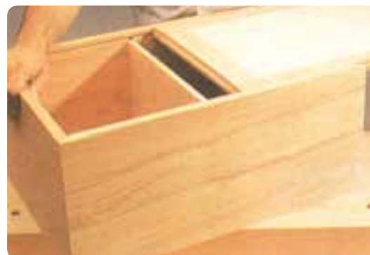
شکل ۱۴۳-۶ قرارگیری پشت بند در کنشکاف بدنه کابینت
