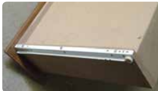
شکل ۶-۱۱۲ نصب ریل مکانیکی در زیر بدنه جعبه
