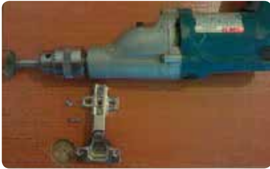
شکل ۱۲۸-۶ نصب لولای کابینت فندار روی در کابینت
