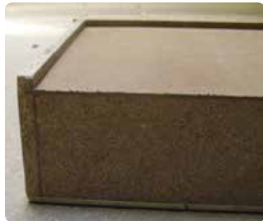
شکل ۶-۱۰۴ نصب کف کشو روی عقب جعبه
