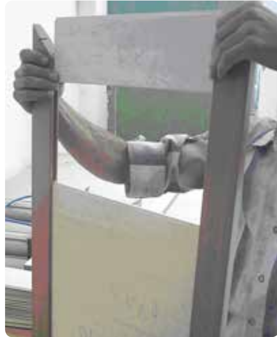
شکل ۶-۹۵ مونتاژ در قابدار با تنگه لته‌ای
