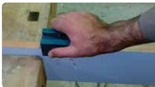
شکل ۶-۸۲ پرداخت لبه اضافی روکش
