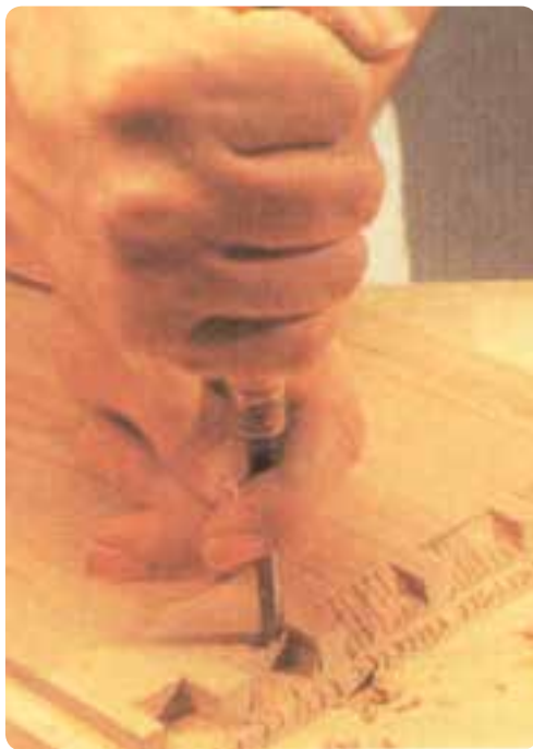
شکل ۶-۱۳۷ درآوردن جای فاق اتصال دم‌چلچله با مغار دستی
