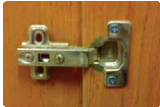
شکل ۸۵-۶ نصب کاسه لولا روی در کابینت
