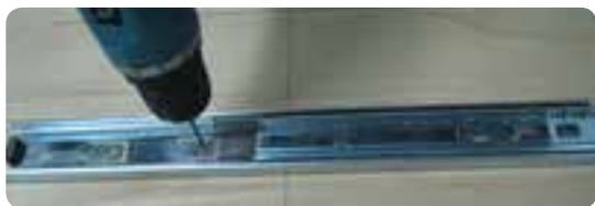
شکل ۷-۳۳ سوراخ‌کاری محل استقرار ریل روی بدنه فایل
