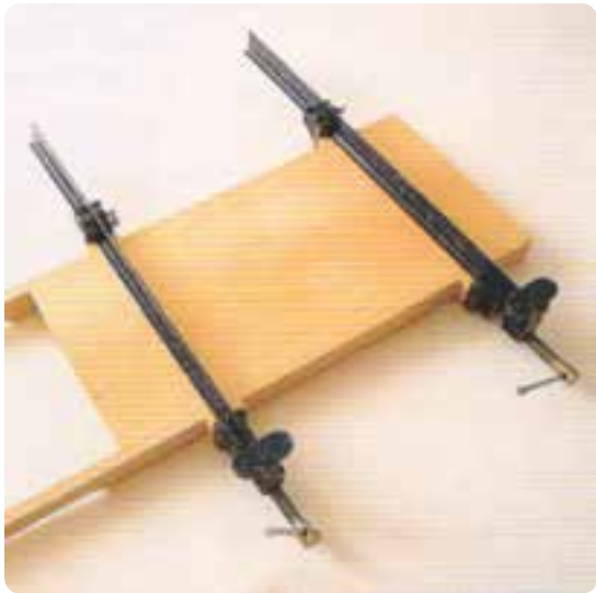
شکل ۵۹-۸ مونتاژ بدنه به پایه
