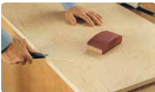
شکل ۷۷-۸ پرداخت لبه های اضافی روکش لبه چسبان
