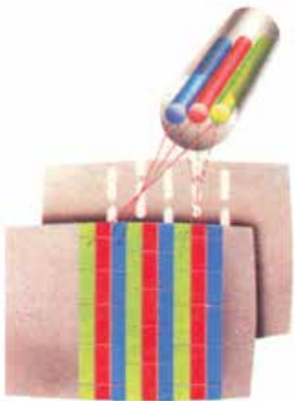
شکل ۲۱-۱ نوارهای رنگی و تفنگ الکترونی در لامپ تصویر ردیفی
