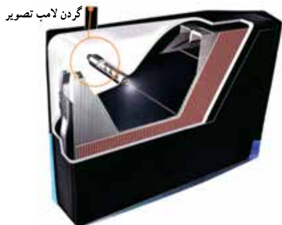
شکل ۱-۳- لامپ تصویر رنگی و گردن آن
