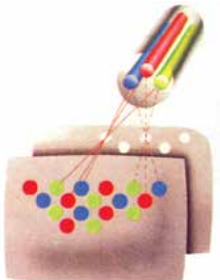
شکل ۱-۲۰- تفنگ الکترونی لامپ تصویر مثلثی ( \Delta )
