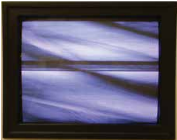
شکل ۱-۴۹ عدم تنظیم فرکانس نوسان ساز افقی
