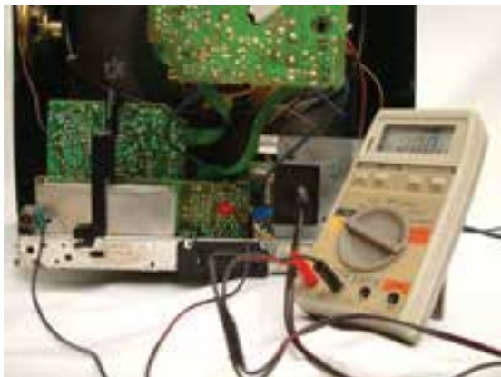
شکل ۱-۶° اتصال ولت‌متر به پایه‌ی ۱۶
