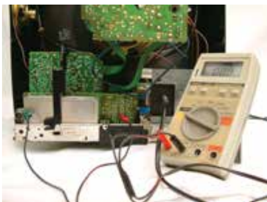
شکل ۱-۶۱° اتصال ولت‌متر به پایه‌ی ۱۰
