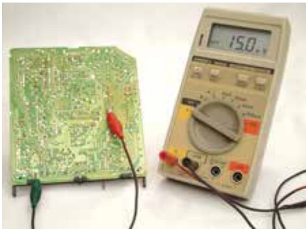
شکل ۱-۵۹- اتصال غیر صحیح مولتی‌متر به پایه‌ی آی‌سی
