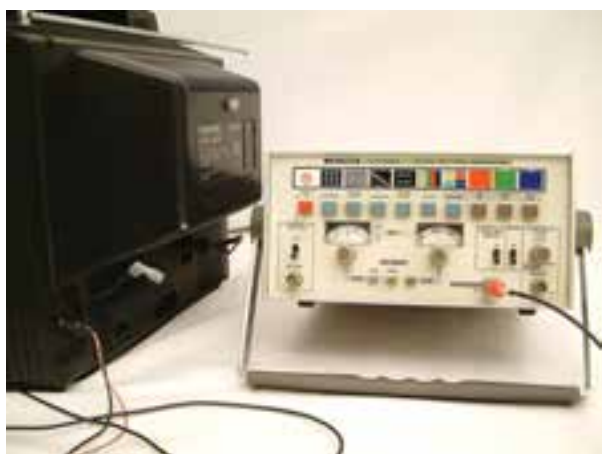
شکل ۱-۷۱- اتصال پترن ژنراتور به تلویزیون
