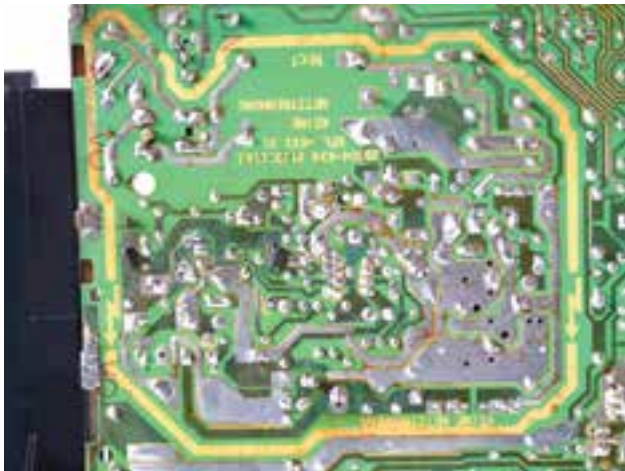
شکل ۱-۵۸- بخشی از مدار که برق ۲۲۰ ولت به آن اتصال دارد.
