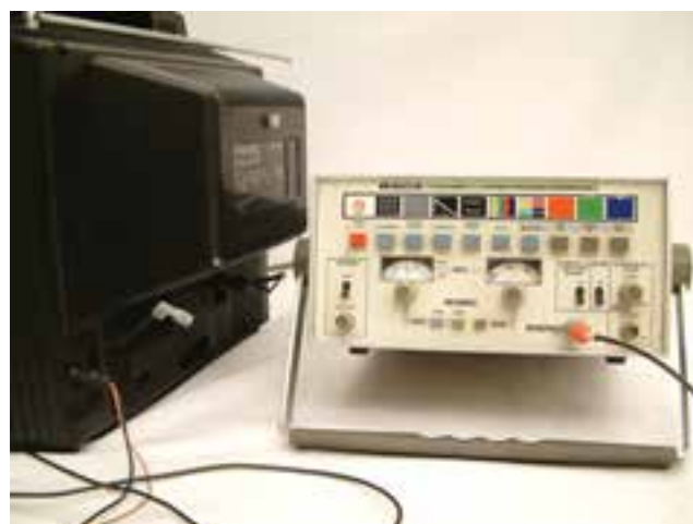
شکل ۱-۱۴۳- اتصال خروجی RF پترن ژنراتور به ورودی آنتن تلویزیون
