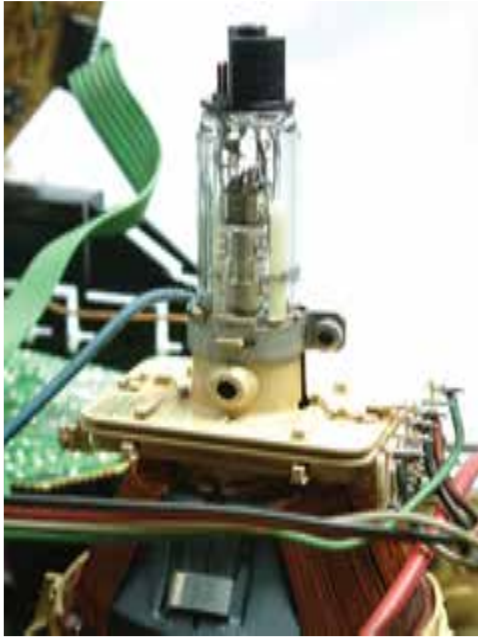
شکل ۱-۷۱-الف - شکل لامپ تصویر و پایه‌های آن
