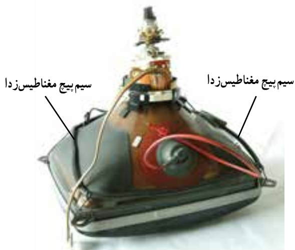
شکل ۱۰۶-۱- سیم پیچ مغناطیس زدا در روی قسمت شیپوری لامپ تصویر
