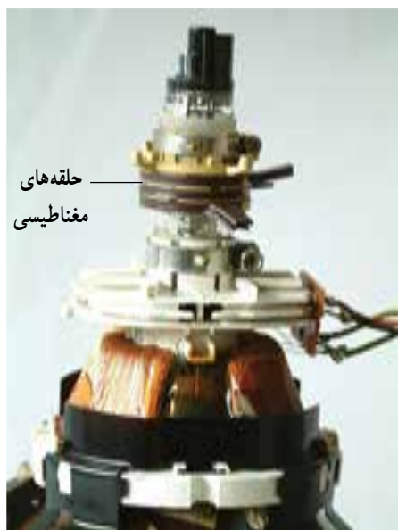
شکل ۹۸-۱- حلقه‌های مغناطیسی روی گردن لامپ
