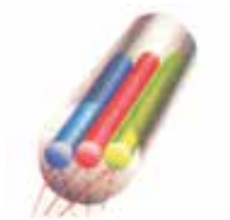
شکل ۹۳-۱- سیستم تولید اشعه In Line
