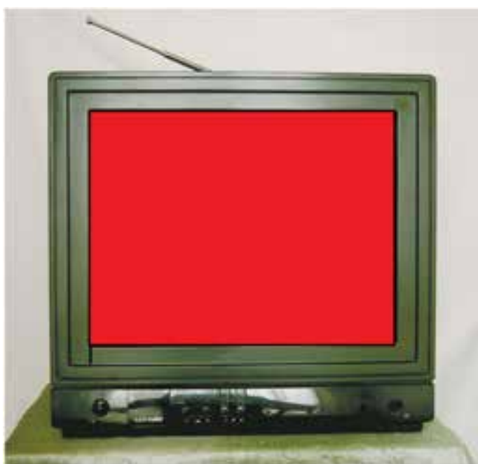
شکل ۱-۸۸- تنظیم صحیح خلوص رنگ
