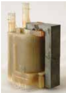
شکل ۱-۱۳۳- شکل ظاهری ترانسفورماتور TR526
