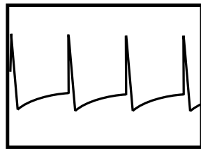
شکل ۱-۱۰۲- ولتاژ L' از ترانس سطر
