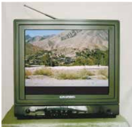
شکل ۲-۷۲- تغییر پتانسیومتر مکان عمودی تصویر را تغییر داده است.
