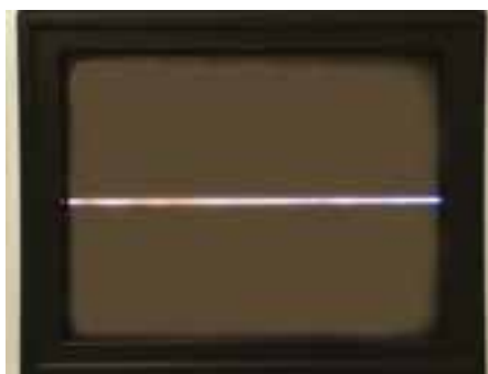
شکل ۲-۴۰- نوسان ساز عمودی از کار افتاده است.
