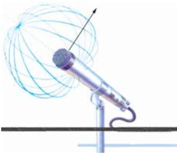
شکل ۱-۱۲۵-۱ منحنی مشخصه میکروفون
