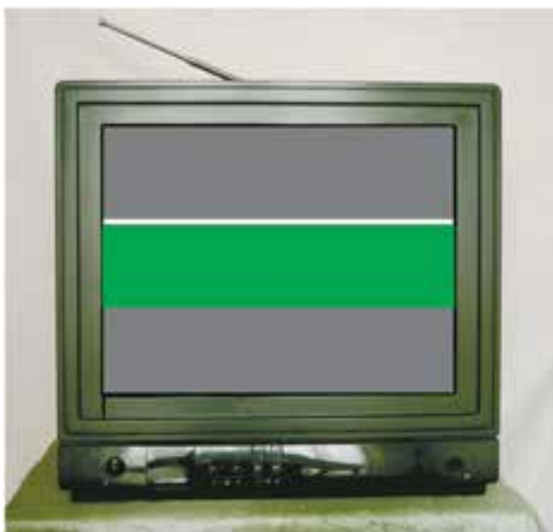
شکل ۲-۱۱۶- تصویر تلویزیون وقتی C518 قطع است.
