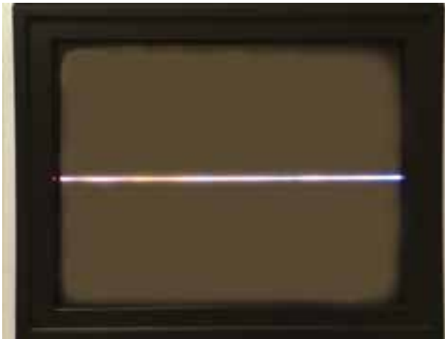
شکل ۲-۸۶- اسیلاتور عمودی از کار افتاده است.
