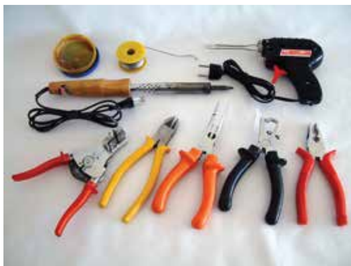
شکل ۹۱-۲- برخی ابزار کارگاه الکترونیک
