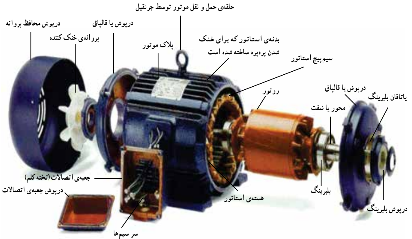
شکل ۱-۳- اجزای اصلی موتور سه فاز
