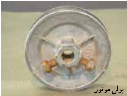
شکل ۱-۲۵- باز کردن پولی موتور
