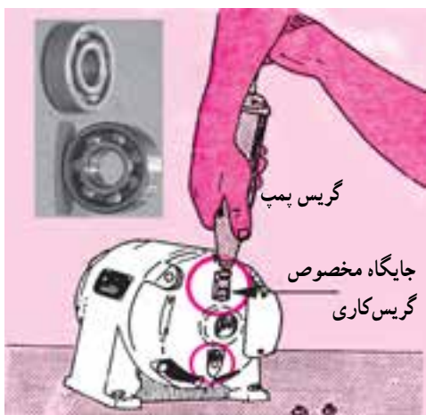
شکل ۱-۳۳ - گریس کاری بلبرینگ‌ها
