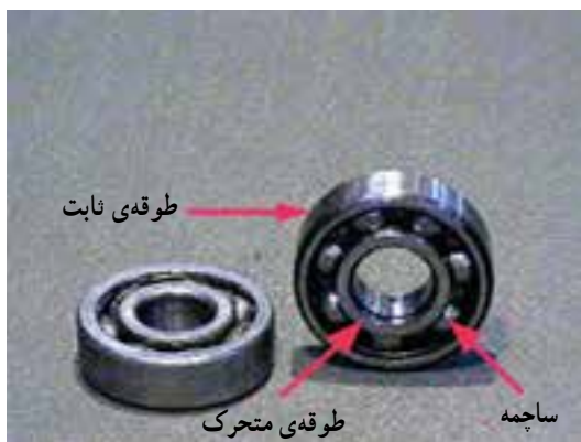
شکل ۱-۳۶ - ساختمان بلبرینگ
