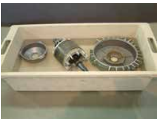
شکل ۱-۳۲ - شست‌وشوی قطعات با آب گرم
