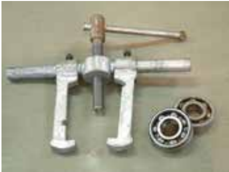
شکل ۱-۴۷- بلبرینگ‌ها پس از جدا شدن از محور
