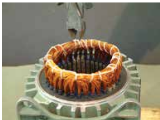
شکل ۲-۱۳ - چیدن نخ‌های کلاف بندی با سیم چین
