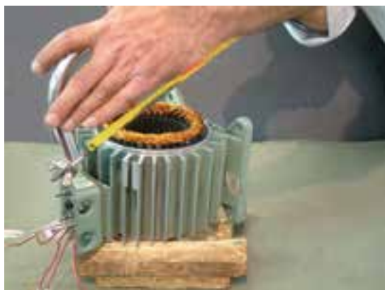
شکل ۱۶-۲- برش پیچک‌ها و شمارش تعداد دور
