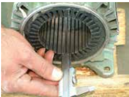
شکل ۲-۳۲- اندازه گیری طول شیار
