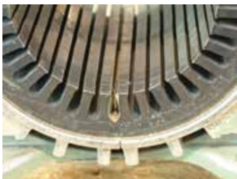
شکل ۲-۳۳- اندازه گیری محیط شیار
