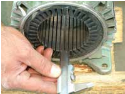
شکل ۲۶-۲- اندازه گیری محیط داخلی و طول شیار
