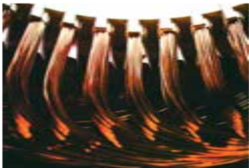
شکل ۲-۳۰- عایق گذاری بین طبقات
