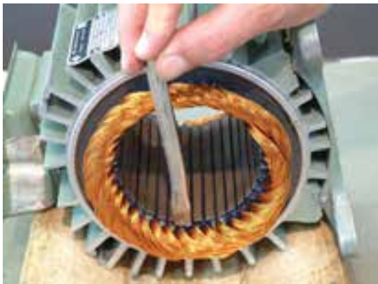
الف - قرار دادن قلم روی سیم‌ها
