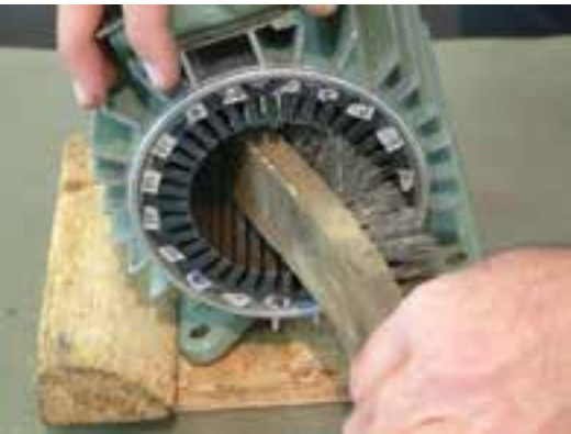
ب – تمیز کردن استاتور با برس سیمی
