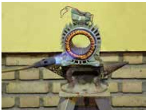
شکل ۲-۱۸- سوزاندن مستقیم سیم‌ها با شعله
