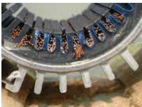
شکل ۲-۲۱ - برس سیم‌ها در یک طرف استاتور
