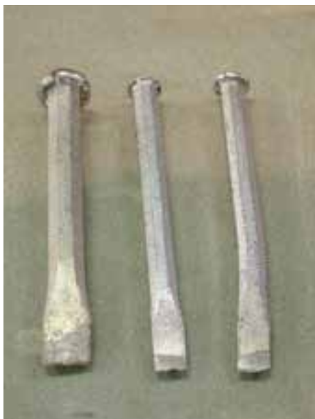
شکل ۲-۱۹- چند نمونه قلم برای بریدن سیم‌ها
