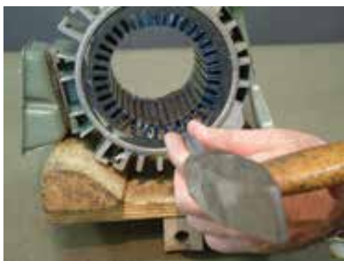
شکل ۲-۲۳ - هدایت سیم‌ها به طرف دوم استاتور
