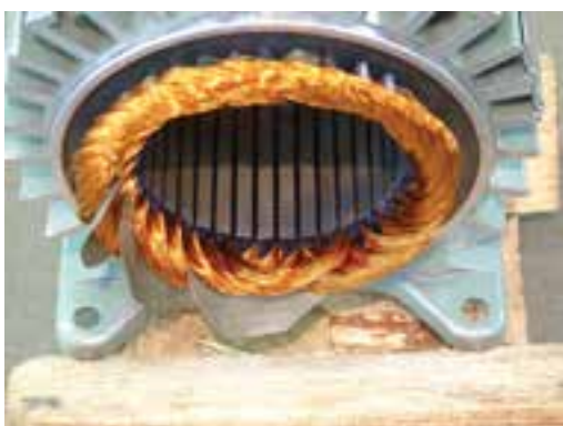
شکل ۲-۳۱- عایق کاری پیشانی کلاف‌ها
