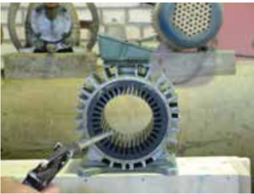
الف – پاک‌سازی خرده سیم‌ها به وسیله‌ی هوای فشرده
