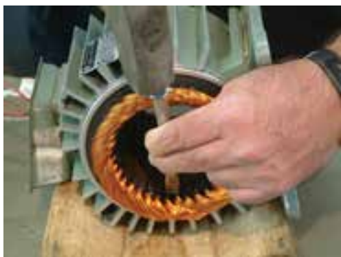
ب - ضربه زدن به قلم شکل ۲-۲۰ - بریدن سیم‌ها به وسیله‌ی قلم
