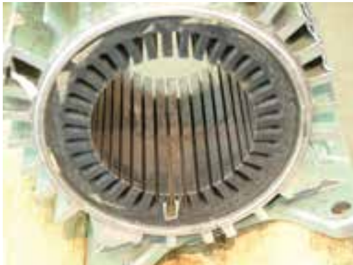
شکل ۲-۳۶- آزمایش عایق در داخل شیار
