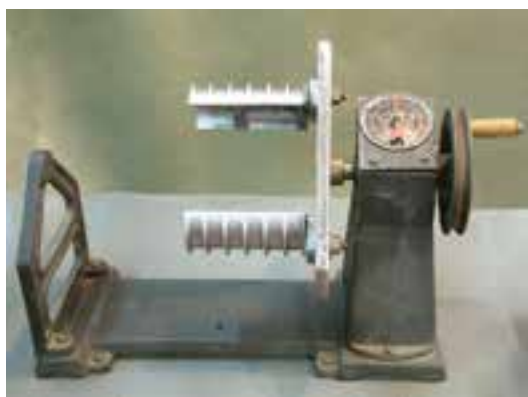
شکل ۱۵-۳- تنظیم اندازه‌ی قالب‌ها در کلاف پیچ
