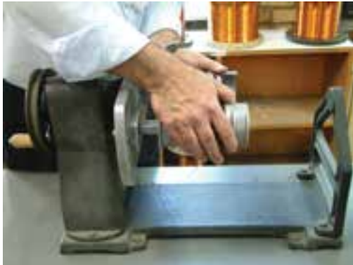
شکل ۱۸-۳- باز کردن قالب‌ها
