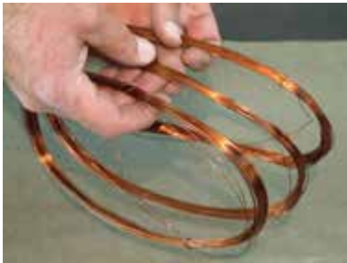
شکل ۱۹-۳- درآوردن کلاف از قالب
