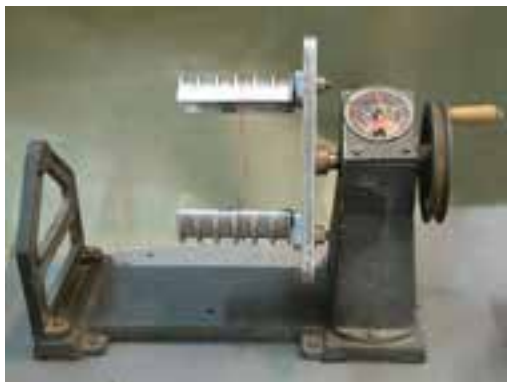
شکل ۳-۵- تنظیم قالب‌ها براساس اندازه‌ی کلاف
