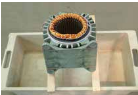
شکل ۴-۲۲- خارج کردن اضافات شارلاک از استاتور
