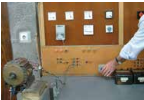
شکل ۹-۶- اتصال موتور به تابلوی برق
