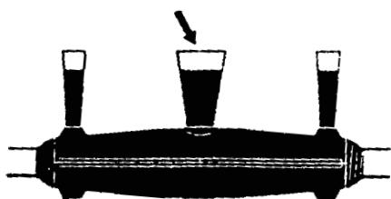
شکل ۲۴-۶- ماده‌ی رزین تا \frac{1}{4} ارتفاع قیف ریخته می‌شود.
