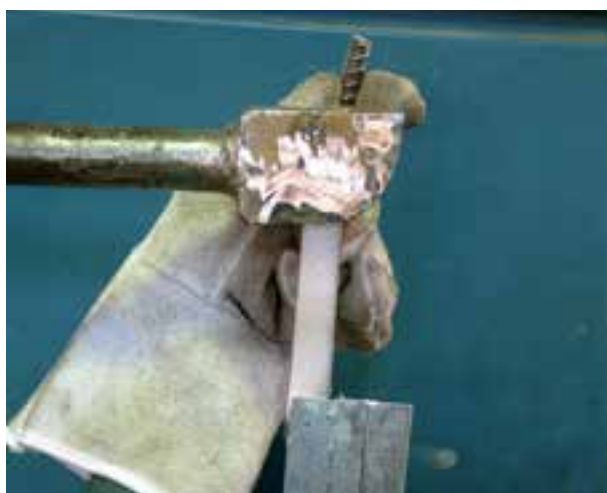
شکل ۱۲۹-۲- نحوه‌ی بستن قطعه به گیره
