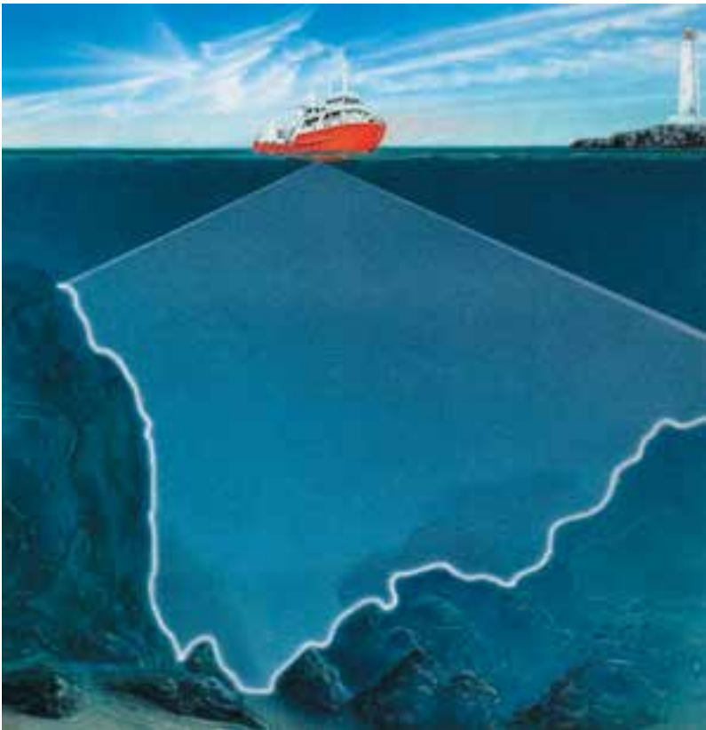
شکل ۱۰- نقشه برداری دریایی (آب‌نگاری)
