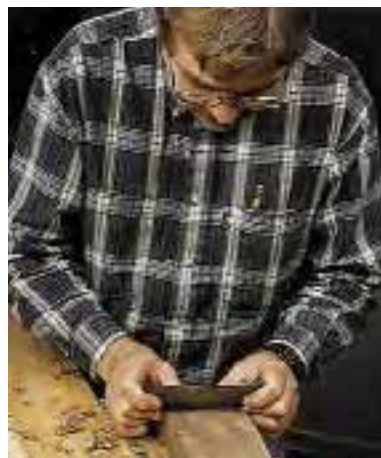
شکل ۲-۳۰. پرداخت سطوح قوس دار به وسیله لیسه.
