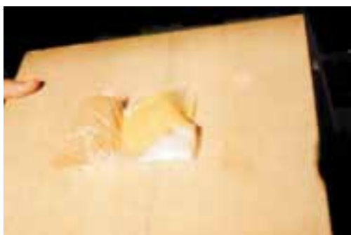
شکل ۱۰-۴- بتونه را می توان داخل نایلون نگه داری نمود تا ماندگاری بیشتری داشته و خشک نشود.
