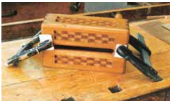
شکل ۹-۷۰- بستن سقف به بدنه‌ها.
