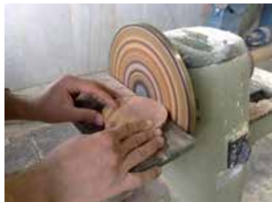
شکل ۱۲-۱۹۱- پرداخت قطعه چوب دایره شکل.
