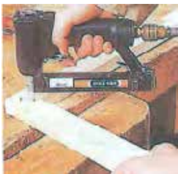
شکل ۳-۸- منگنه‌زن بادی (فشاردهنده‌ی هوا) با منگنه‌زن بادی.
