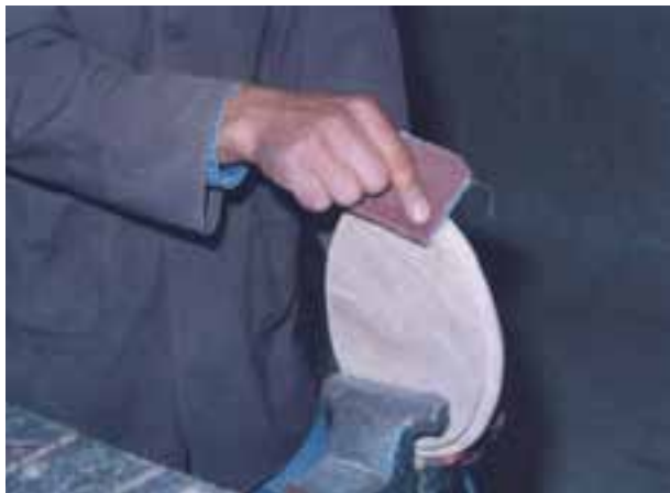
شکل ۳-۱۲- با سفت کردن گیره‌ی بالا، آه (روی فک‌ها، به قطعه کار آسیب می‌رساند).
