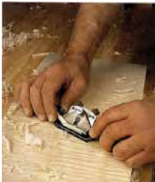
شکل ۳۶-۲. با رنده بال کبوتری نیز، می‌توان سطوح چوبی را پرداخت کرد.
