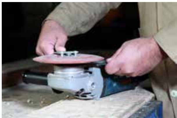
شکل ۷-۲۰- بستن ورق سنباده روی دیسک لاستیکی و مکم کردن آن با مهره‌ی مخصوص.
