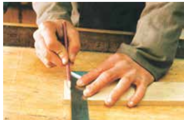
شکل ۹-۶۳. فم کشی ممل اتصال با گونیا.
