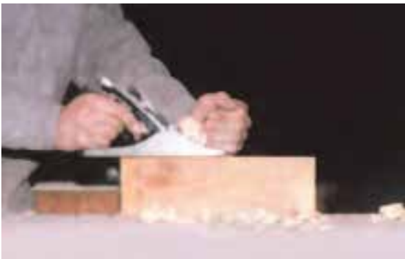
شکل ۲۳-۲- رندیدن سر چوب، به کمک دو قطعه چوب کمکی.
