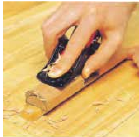
شکل ۲۶- نمونه ی پرداخت قطعه ای با مقطع نیمگرد.
