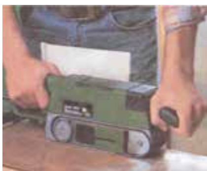
شکل ۴-۷. روش کنترل و کاربرد صمبغ دستگاه.
