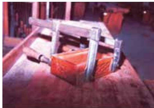
شکل ۹-۶۹- مونتاژ بدنه‌های جعبه.
