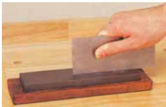
شکل ۲-۸- نمونه‌ی قرار دادن ضخامت لیسه روی سنگ نفت.
