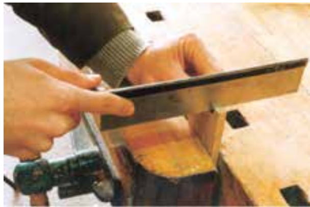
شکل ۹-۶۵. برش فاق و زبانه‌ها با اری ظریف‌بر (پشت‌دار).
