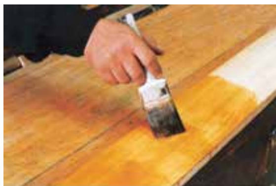
شکل ۴-۴۴- لبه‌ی تیغه‌ی قلم‌مو را، در جهت فلاف الیاف و با زاویه‌ی ۹۰ درجه بکشید.
