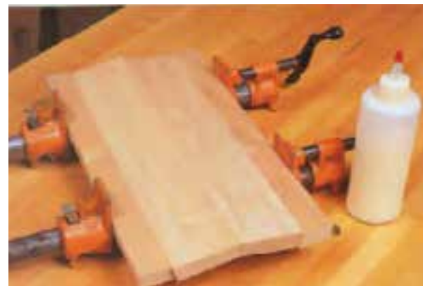
شکل ۱۴۵- هنگام چسباندن تفتنه‌های درز شده به وسیله‌ی تنگ، نباید فشار تنگ، بیش از حد باشد، زیرا تفتنه‌ها قوس بر می‌دارد.
