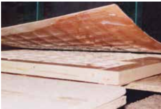
شکل ۱۱-۳۷- قرار دادن صفحه‌ی دوم، روی کلاف.
