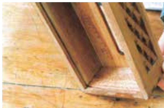
شکل ۹-۶۷- کنشکاف داخل بدنه‌های یک جعبه دستمال کاغذی.
