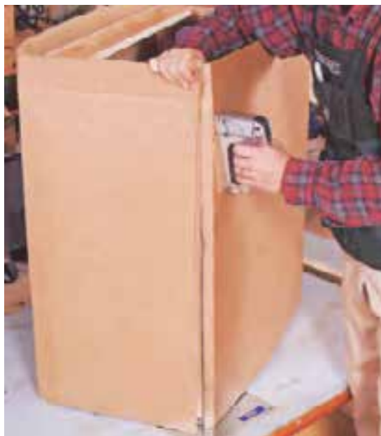
شکل ۸-۲۲- کاربرد منگنه‌ی دستی در بسته‌بندی کالاها.
