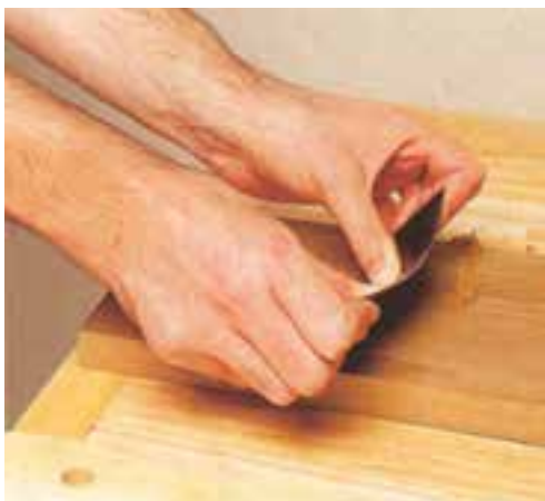
شکل ۲-۱۲- از فم کردن زیاد لیسسه هنگام لیسسه‌کاری فودداری شود.
