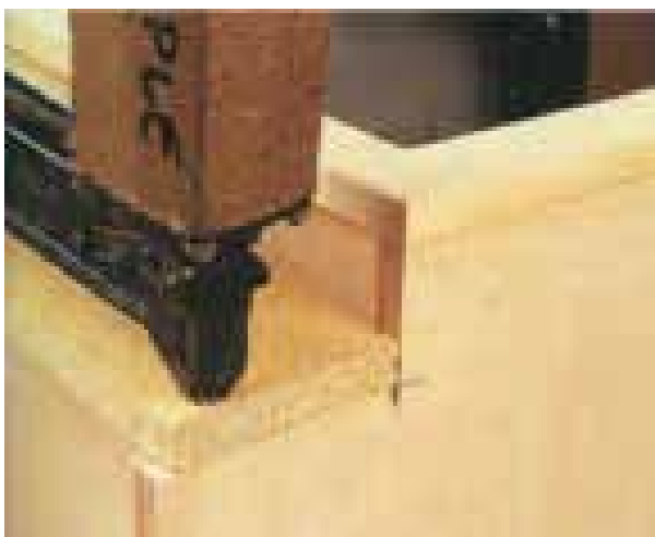
شکل ۸-۲۰- اتصال تخته خرده چوب به کابینت.
