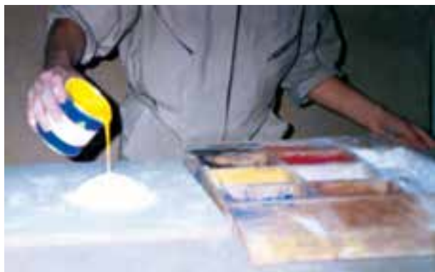
شکل ۴-۳- مواد تشکیل‌دهنده‌ی بتونه روغنی.
