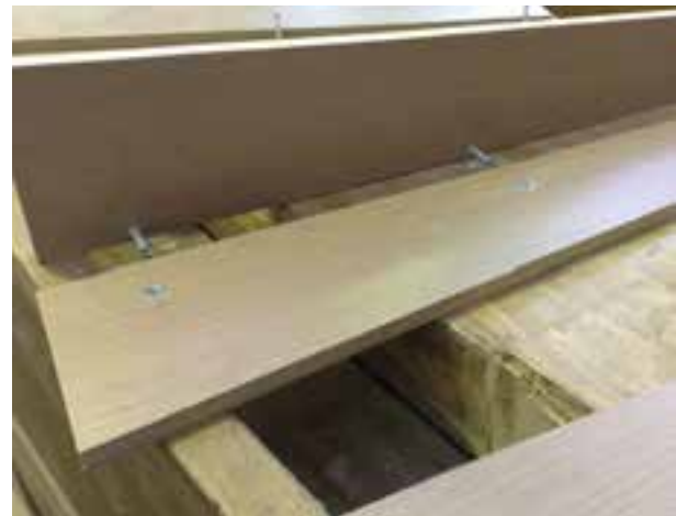
شکل ۱۲-۱۵. اتصال پایه‌ها به یکدیگر، با استفاده از اتصال الیت.
