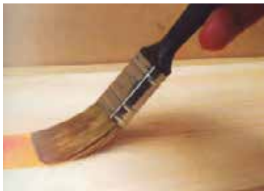
شکل ۴-۴۳- قلم‌مو را در جهت الیاف چوب بکشید.
