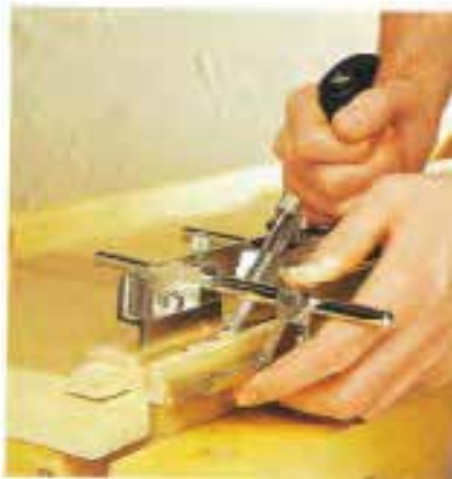
شکل ۹-۱۰۰- شیار انداختن داخل قیدهای عرضی.
