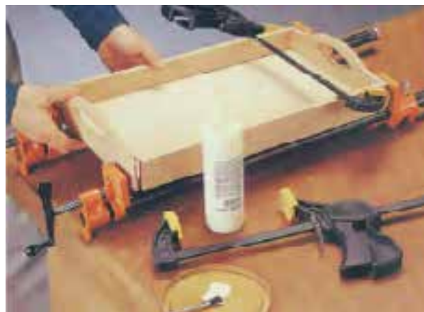
شکل ۱۴۳- برای چسباندن قطعات بزرگ، می‌توان از تنگ دستی استفاده نمود.
