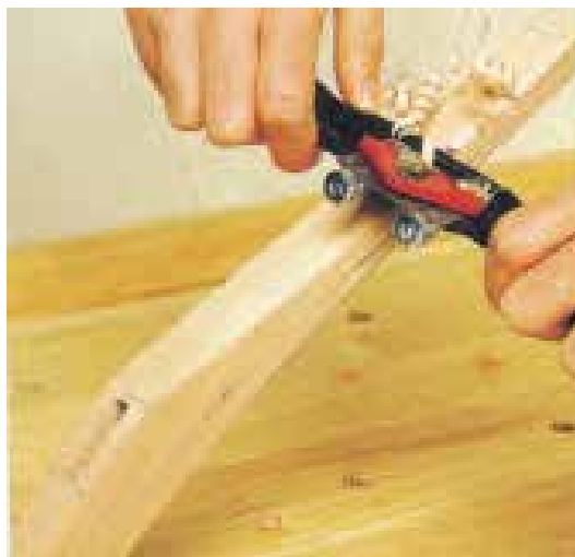
شکل ۳۵-۲. با رنده بال کبوتری، می‌توان لیسه را به طرف فود هدایت کرد.
