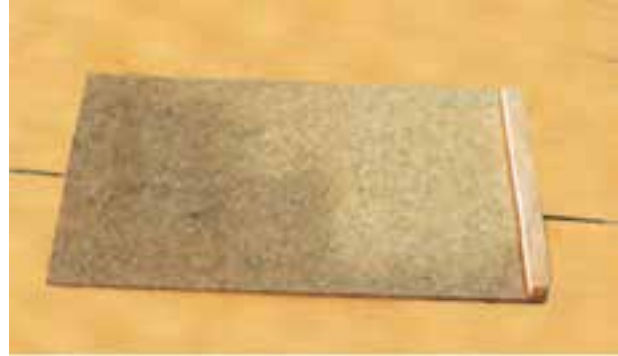
شکل ۹-۶۲. پسباندن زهوار به لبه‌ی کف جعبه.
