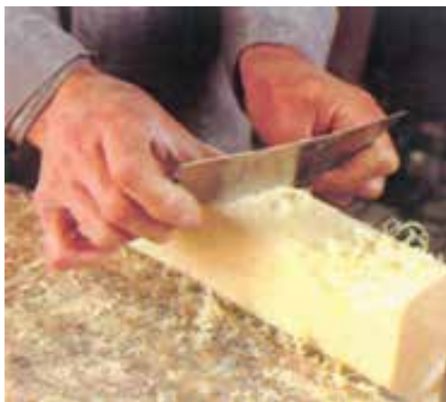
شکل ۲۹- برای لیسه کاری، لیسه را کمی خم کرده روی سطح چوب هدایت کنید.
