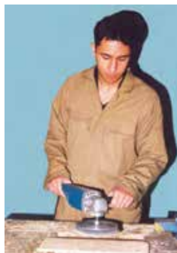
شکل ۷-۴۰- هدایت و کنترل صمبغ دستگاه سنباده.
