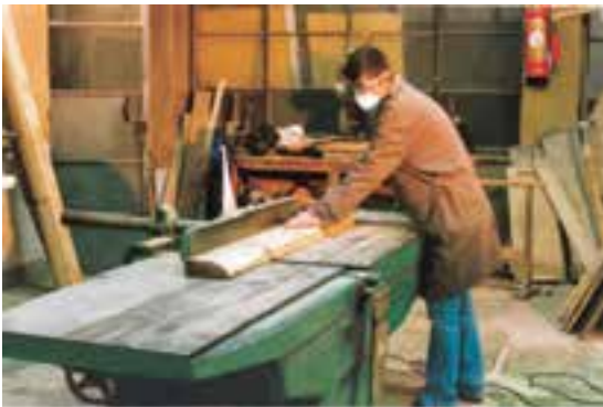
شکل ۹-۹- مقدار باز بودن زیاد گونیا، فطرآفرین است.
