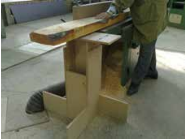
شکل ۹-۱۴- کاربرد میز کمکی برای ماشین کفرند.
