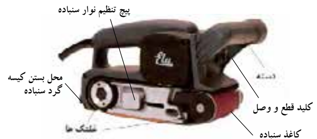
شکل ۷-۵- امزای مهم و کاربردی دستگاه سنباده نواری.
