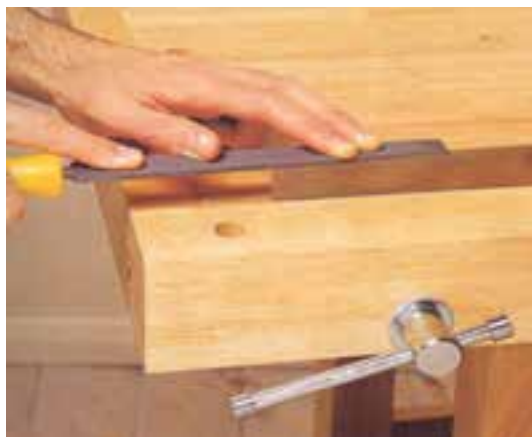
شکل ۲-۷- نمونه‌ی سوهان زدن ضخامت لیسه.
