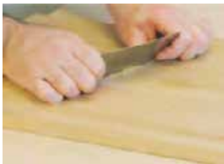
شکل ۲-۱۳- جهت حرکت لیسسه، هنگام پُرزگیری.
