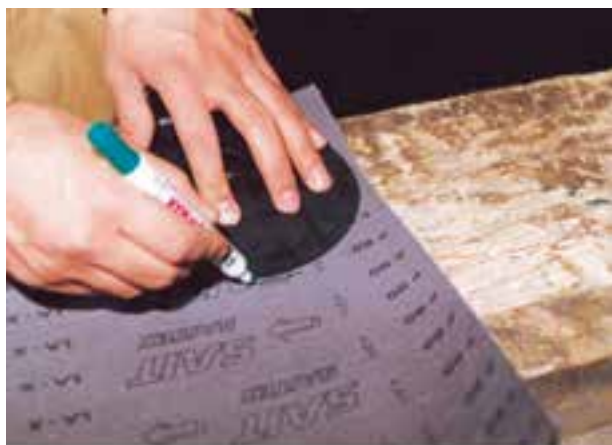
شکل ۷-۳۵- ترسیم گردی دیسک روی سنبله.
