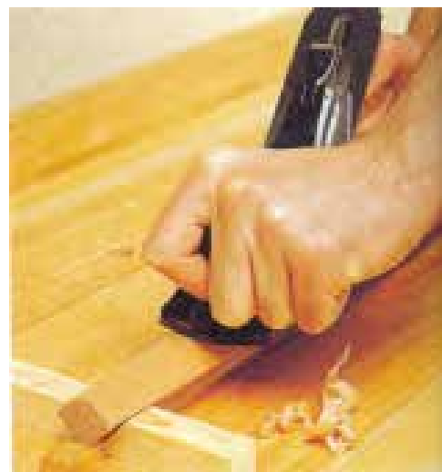
شکل ۲۷- نمونه ی پرداخت قید شش ضلعی با رنده پرداخت.
