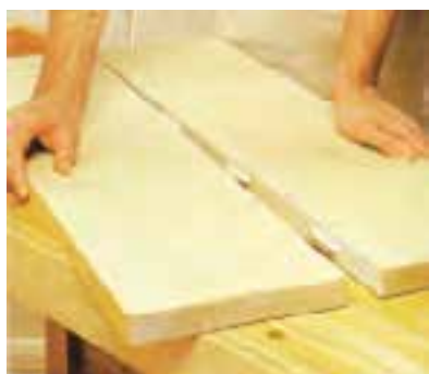
شکل ۹۴- صفحه‌ی رویه، با اتصال بیسکویتی.
