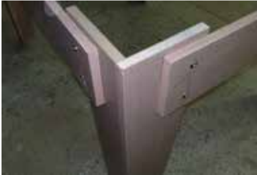
شکل ۱۲۱۶ اتصال پایه به قید توسط پیچ فیکس.
