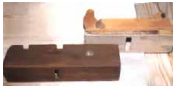
شکل ۲-۱۷- پس از پایان کار، رنده‌ها به پهلو خوابانده شود.
