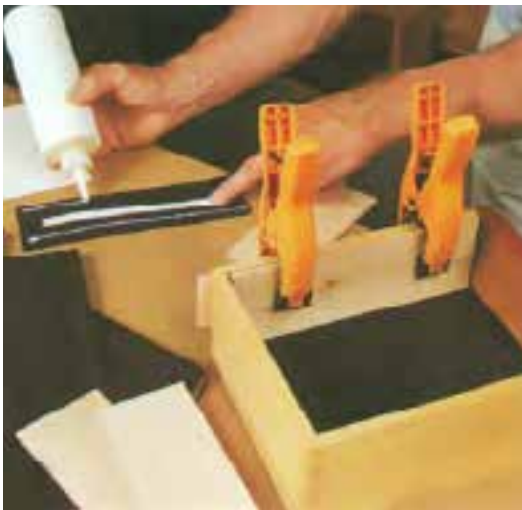
شکل ۱۴۱- برای بستن قطعات نازک، باید از گیره‌ی انبری استفاده نمود.
