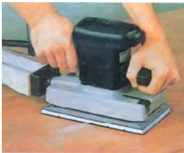
شکل ۳-۱۴- سنباده‌زنی با یک دستگاه سنباده لرزان کامل.
