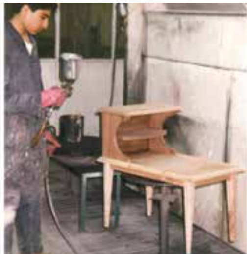
شکل ۲۴-۴. رنگ‌کاری با پیستوله (رنگ شفاف).
