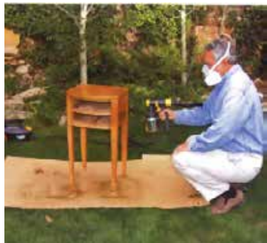
شکل ۲۳-۴. رنگ‌کاری با پیستوله (رنگ پوششی).
