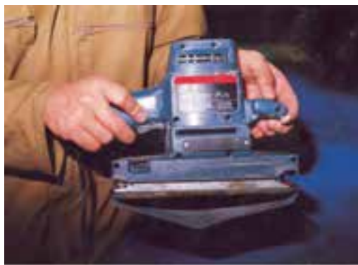
شکل ۷-۴۶- شل و سفت بستن سنباده به دستگاه.
