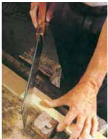
شکل ۱۰-۱۱- برش زهوار، با زاویه‌ی ۴۵ درجه.
