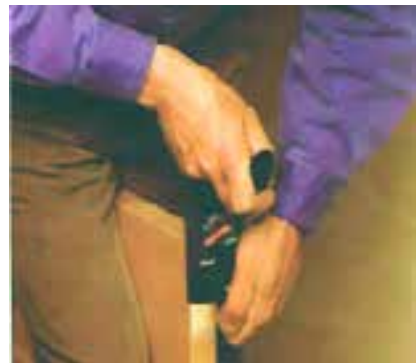
شکل ۲۱-۲- برای رندیدن سر چوب، رنده از خارج به داخل هدایت می‌شود.
