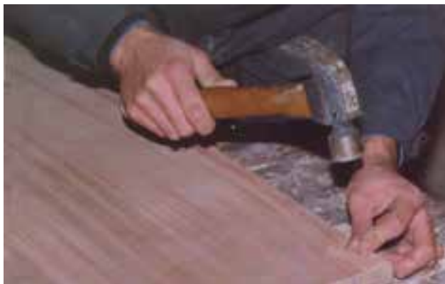
شکل ۱۱-۳۳- میخ کردن موقت صفحه به کلاف، به وسیله‌ی میخ و فیبر.
