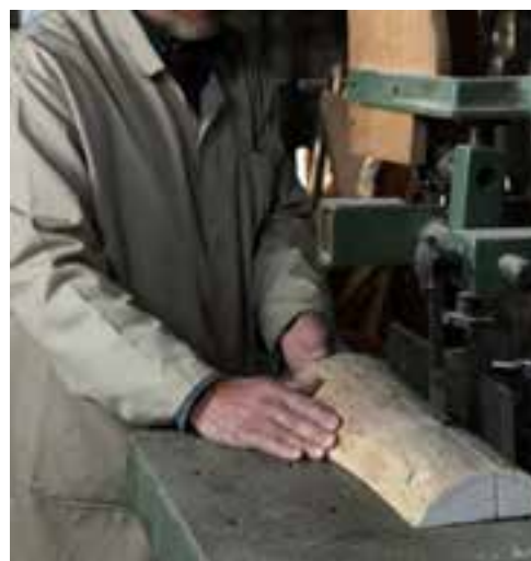
شکل ۹-۴- دستگاه هدایت، حداقل ۲ سانتی‌متر از سطح کار، بالاتر باشد.
