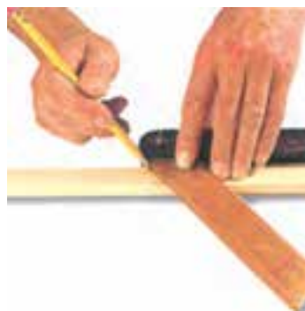
شکل ۱۰-۱۰- فلماکشی زهوار، با زاویه‌ی ۴۵ درجه.
