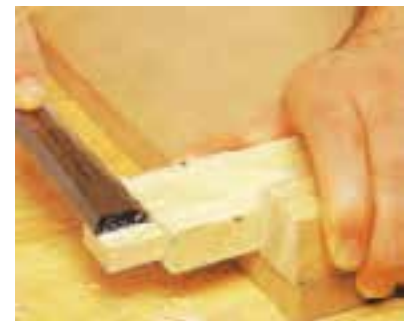
شکل ۹-۹۸- اندازه کردن زبانه با مغار.
