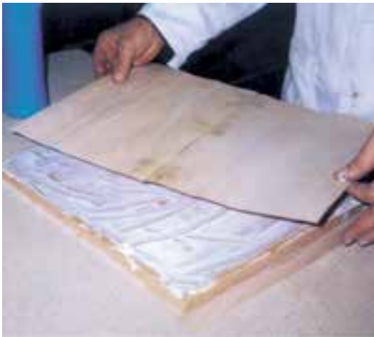
شکل ۱۷-۶- پس از چسب‌کاری صفحه‌ی مصنوعی، روکش آماده را روی آن قرار دهید.
