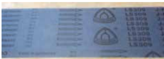
شکل ۷-۳۲- هنگام سوار کردن نوار سنبناده روی دستگاه، به جهت فلش‌ها و حرکت غلتک‌ها توجه کنید.
