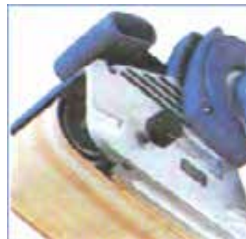
شکل ۷-۶- با این پیچ می‌توان غلتک جلو را حرکت داد.
