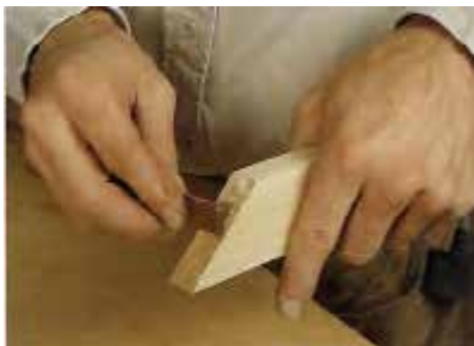
شکل ۱۴۶- برای چسباندن دو سر چوب به یکدیگر، باید چسب زنی را یکبار انجام داد، و پس از نمو شدن چسب هنگام بستن قطعات، مجدداً به سر چوب چسب زد.
