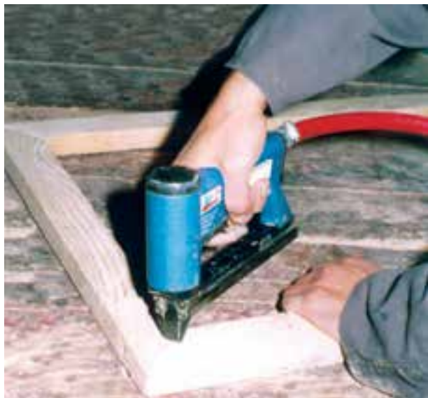
شکل ۸-۱۶- منگنه زدن روی درزهای ۴۵ درجه شده.
