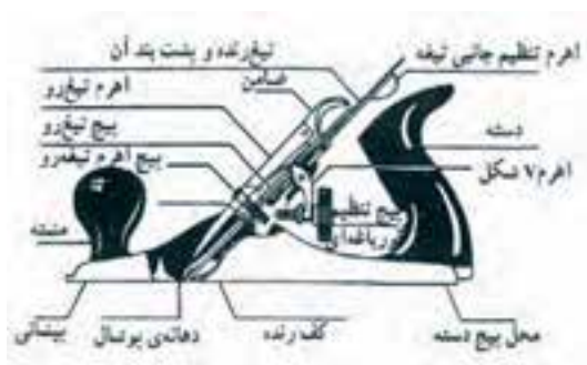
شکل ۲-۳- رنده‌ی دو تیغ فلزی
