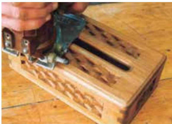
شکل ۹-۷۱- فرز کاری لبه‌های کار و شیار محل خروج دستمال کاغذی.
