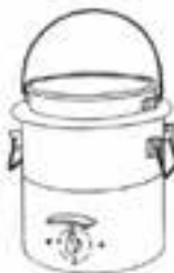
شکل ۱-۳. ظرف سربشم الکتریکی با جای آب از ورق مس.
