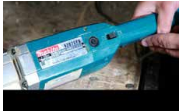
شکل ۷-۲۲- کلید تعیین دور برای سنباده‌کاری سطوح مختلف، با سفتی‌های متفاوت.
