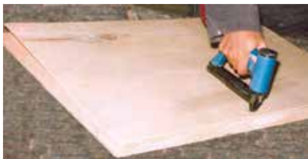
شکل ۲۱-۶- ثابت کردن روکش روی صفحه‌ی کار توسط منگنه.
