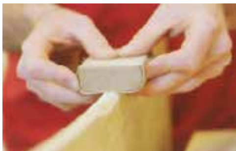
شکل ۳-۲۱. طریقه‌ی سنباده‌کاری نر قطعات با دو دست.
