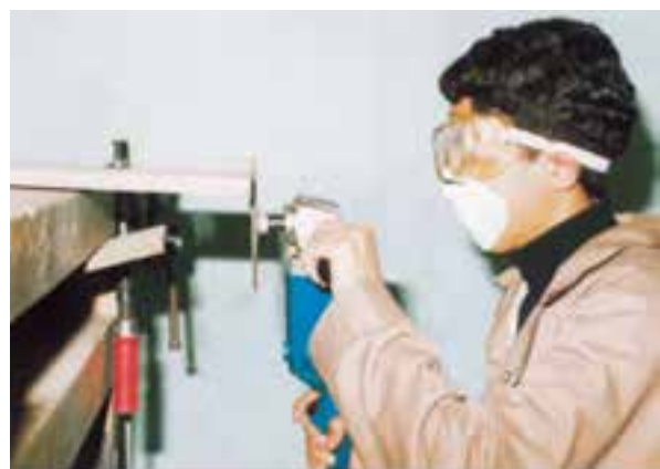
شکل ۷-۴۳- سنباده‌کاری قسمت‌های باریک به مهارت و تسلط کافی در کار نیاز دارد.
