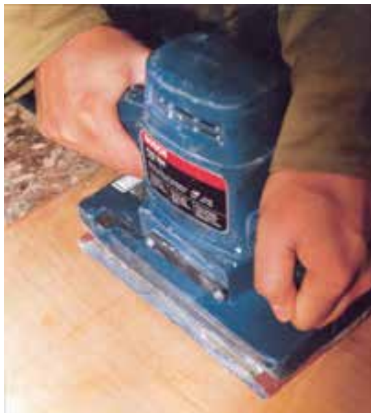
شکل ۷-۱۱- سنباده کاری در جهت الیاف.
