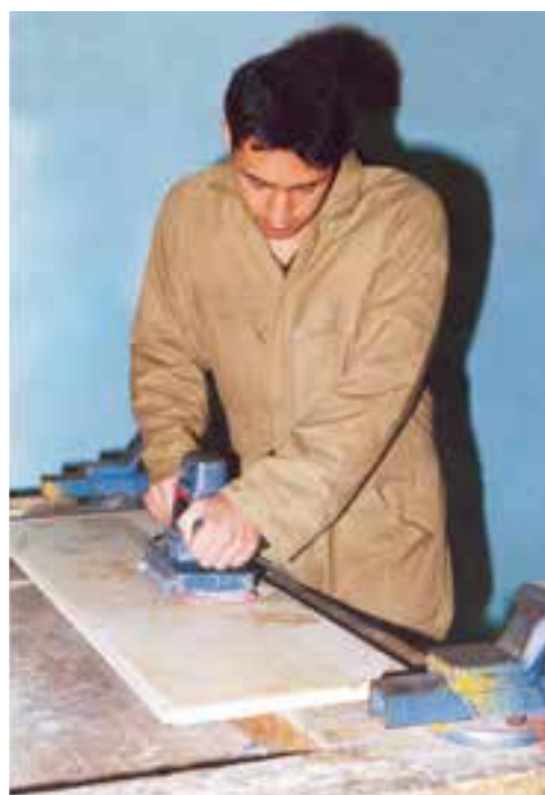
شکل ۷-۱۰- پیچونگی کنترل دستگاه سنباده لرزان.
