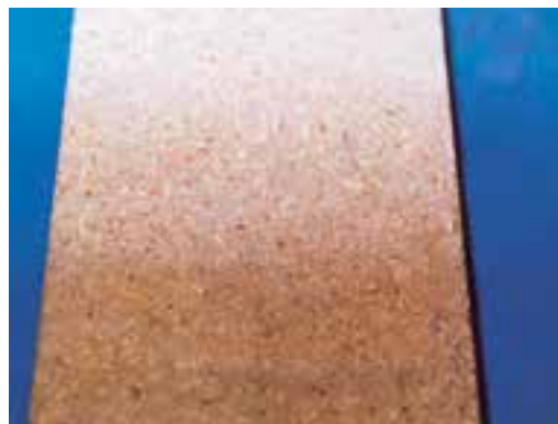
شکل ۴-۲- سطوح تخته خرده چوب، به دلیل فلل و فرج بسیار و شکل
