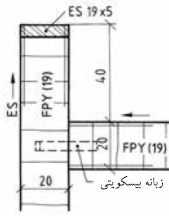
شکل (۴-۶۷) ترسیم علائم نقشه اتصال میانی صفحه به بدنه کابینت با قلیف زبانه بیسکوییتی با اندازه گذاری متناسب
