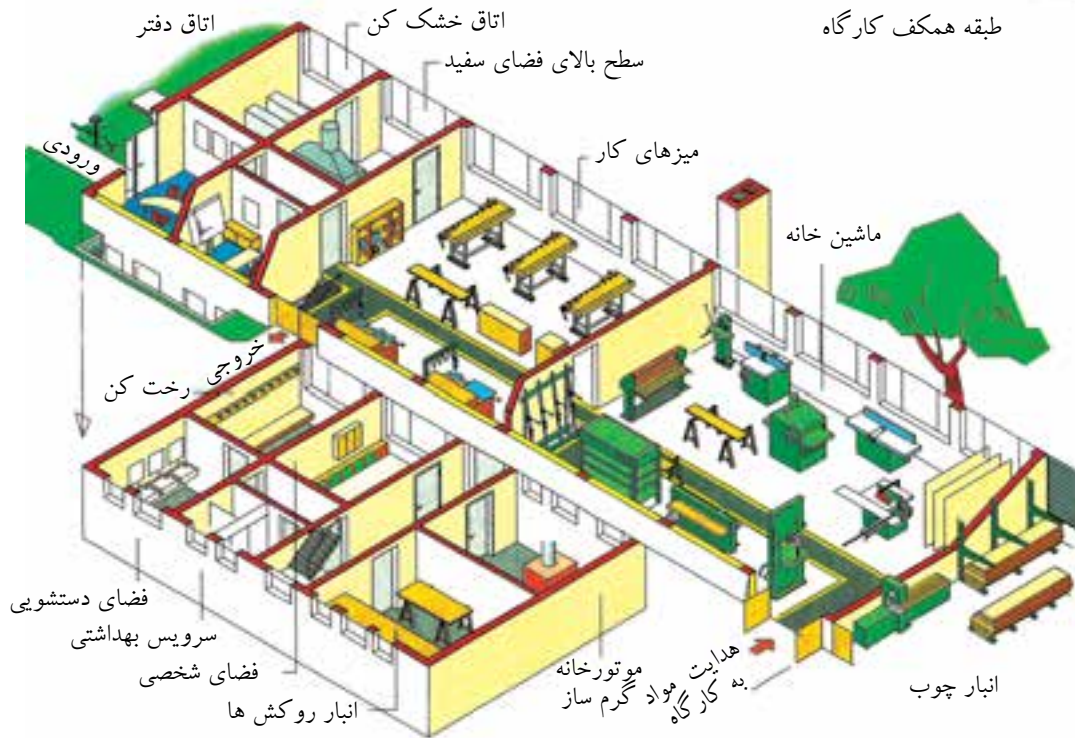
شکل (۴-۶۰) نقشه استقرار ماشین آلات و تاسیسات و میز کار و مواد در تصویر مجسم از کارگاه بزرگ صنایع چوب
