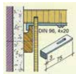
شکل (۴-۴۹) یراق برای آویزان کردن کابینت دیواری با فلز لبه گونیاپی و شکاف پیچ نشان داده شده است.
