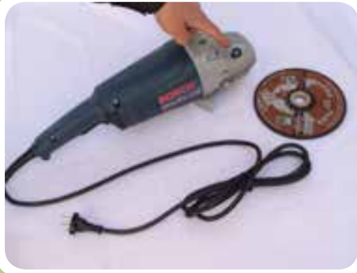
کلید مخصوص قفل کردن محور سنگ
