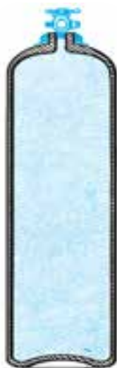
کپسول فولادی مخصوص برای ذخیره اکسیژن
