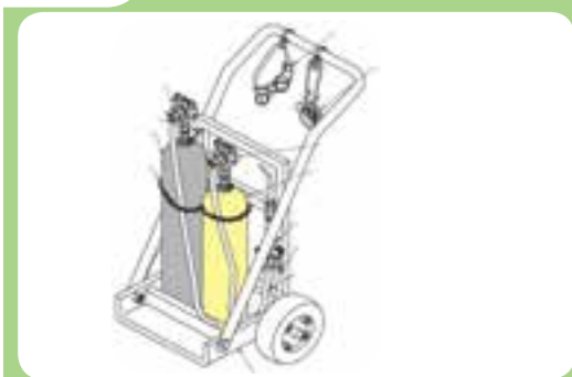
گاری مخصوص حمل کپسول‌های گاز در کارگاه
