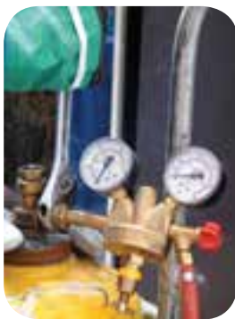
محکم کردن اتصالات رگولاتور به کپسول گاز
