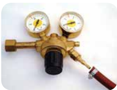
اتصال شیلنگ به رگولاتور گاز
