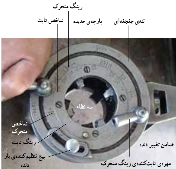
شکل ۴-۵۵- اجزای حدیده‌ی دستی چهار پارچه
