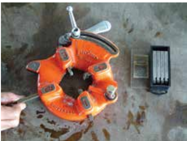
شکل ۴-۹۲- جا زدن پارچه‌ها در شیارهای تنه‌ی حدیده
