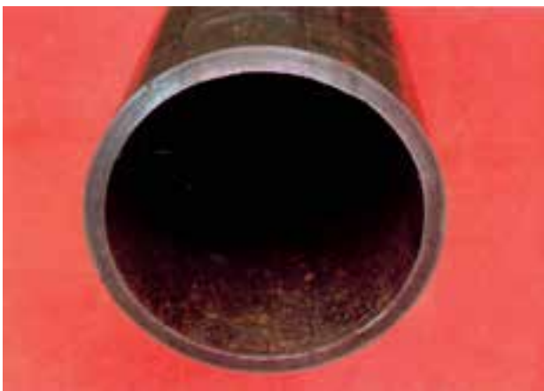
شکل ۴-۱۳- لوله‌ی فولادی بدون درز
