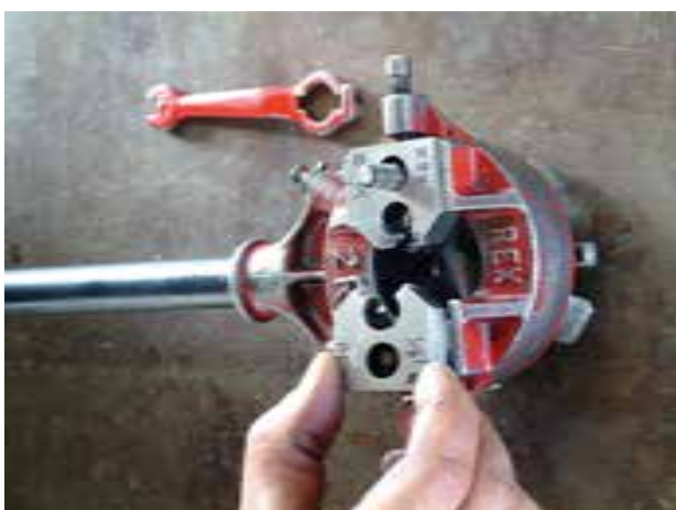
شکل ۴-۲۶ قرار دادن پارچه‌ها در محل خود
