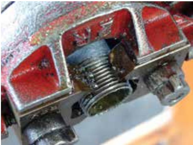
شکل ۴-۳۶- عبور دو دندانه از انتهای پارچه
