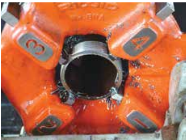
شکل ۴-۸۰- لوله در حال باز شدن از پارچه‌ها
