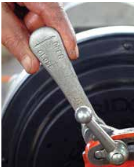
شکل ۴-۹۷- کشیدن ضامن تنظیم به عقب
