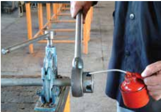
شکل ۴-۴۹- روغن کاری محل تماس پارچه‌ها با لوله
