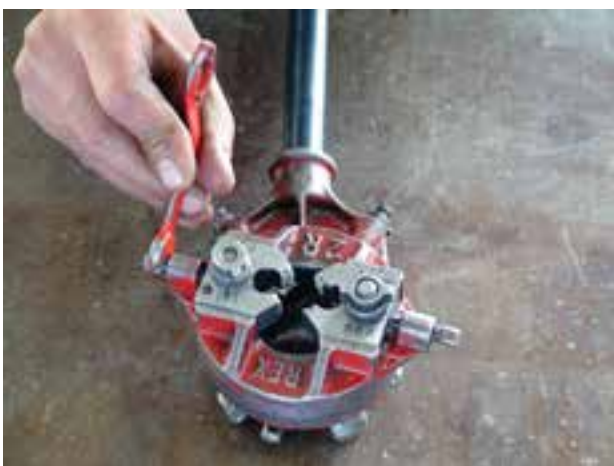
شکل ۴-۲۹- تنظیم کردن حدیده به وسیله‌ی آچار حدیده
