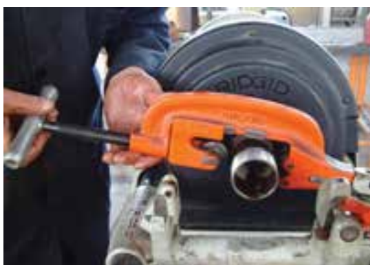
شکل ۴-۱۰۱- بریدن لوله به وسیله‌ی لوله‌بُر
