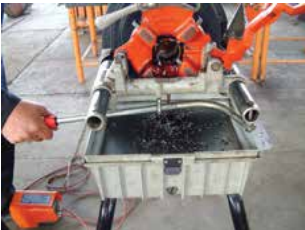
شکل ۴-۸۵- پلیسه‌های ریخته شده بر روی صفحه‌ی مشبک حاصل از عمل حدیده‌کاری
