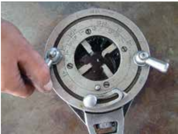
شکل ۴-۵۷- قرار گرفتن ضامن در حالت F و شل کردن مهره‌های ثابت کننده‌ی رینگ متحرک
