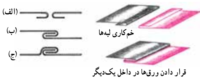
شکل ۴-۲- مراحل مختلف اتصال پیچک
