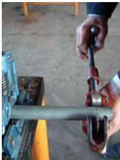
شکل ۴-۷۷- لوله‌بُر در حال گردش به دور لوله
