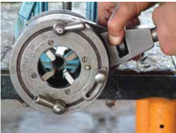
شکل ۴-۵۶- قرار دادن ضامن در حالت F
