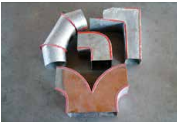
شکل ۴-۳- استفاده از پیچک در ساخت کانال‌های توزیع هوا
