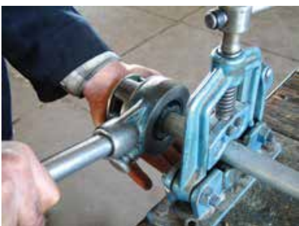
شکل ۴-۴۷- شروع دنده کردن لوله
