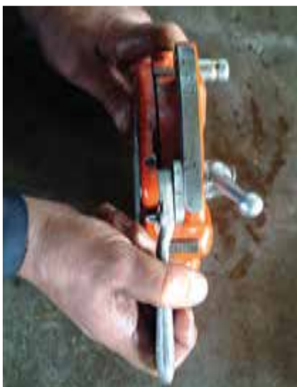
شکل ۴-۹۳- تنظیم حدیده به اندازه‌ی لوله‌ی ۲ اینچ
