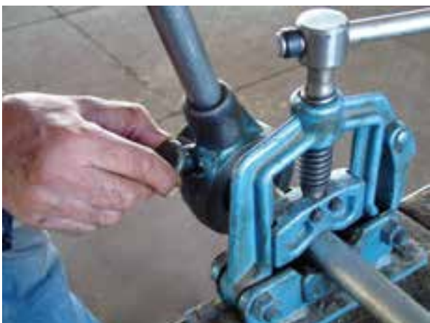
شکل ۴-۴۶- قرار دادن ضامن در جهت حدیده کردن
