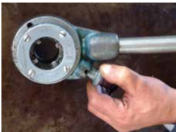
شکل ۴-۴۳- خارج کردن ضامن از شیار
