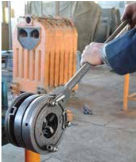
شکل ۴-۶۷- دنده کردن لوله
