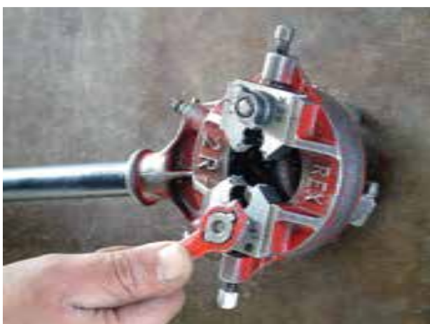
شکل ۴-۲۸- سفت کردن مهره به وسیله‌ی آچار حدیده
