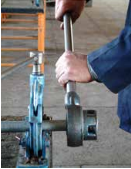
شکل ۴-۴۸- عمل حدیده کاری
