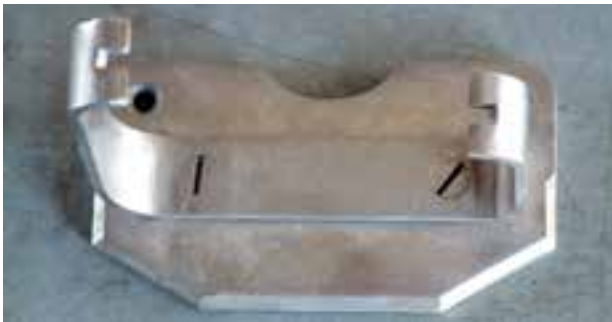
شکل ۴-۵- اتصال موقت با استفاده از پیچ
