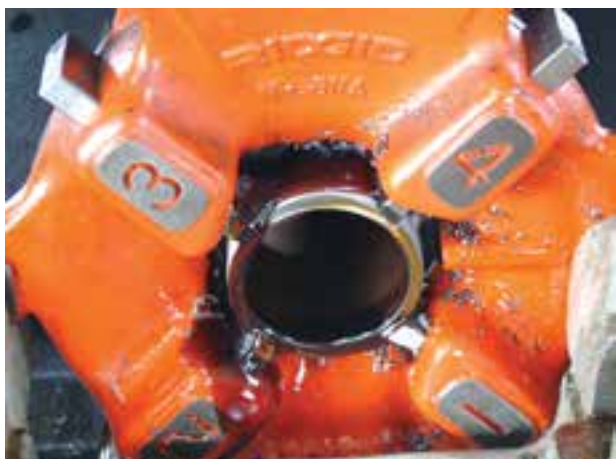
شکل ۴-۹۵- عمل حدیده‌کاری به وسیله حدیده‌ی ماشینی
