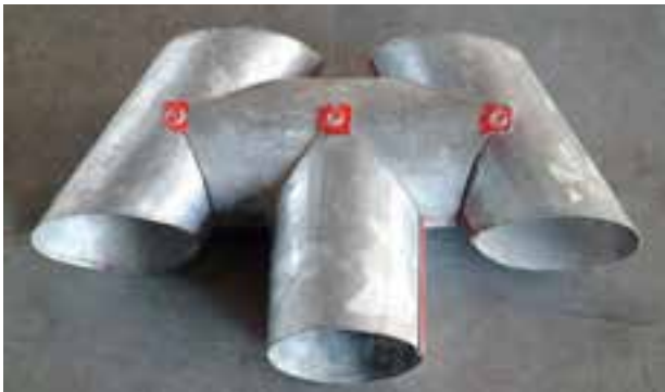
شکل ۴-۱- اتصال چند قطعه به روش پرچ‌کاری
