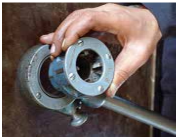
شکل ۴-۴۴- خارج کردن پارچه از بدنه‌ی حدیده
