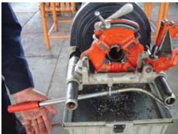
شکل ۴-۹۸- کشیدن اهرم به عقب پس از حدیده‌کاری
