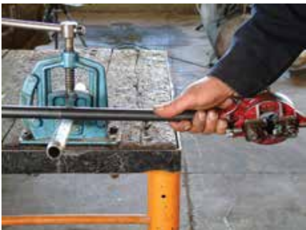
شکل ۴۰-۴ جدا کردن پلیسه‌ها از سردنده
