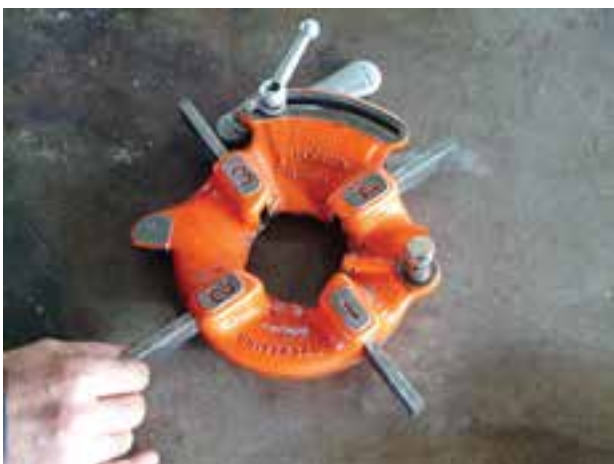
شکل ۴-۹۱- مرحله‌ی اول: ترتیب قرارگیری پارچه‌ها در شیارهای تنه‌ی حدیده
