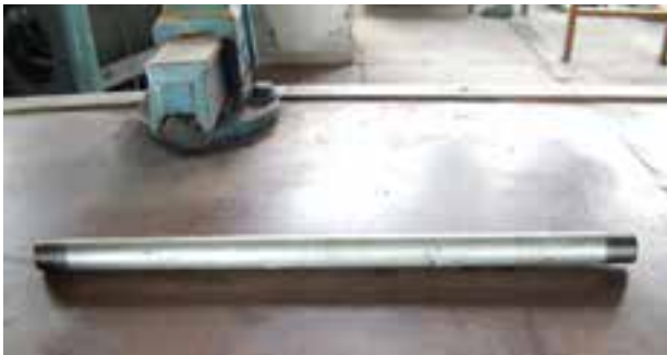
شکل ۴-۶- لوله ی دو سر دنده شده
