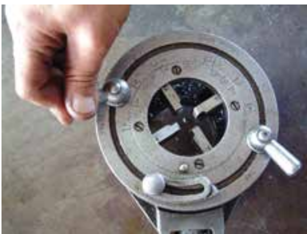
شکل ۴-۶۲- سفت کردن مهره‌های ثابت‌کننده‌ی رینگ متحرک
