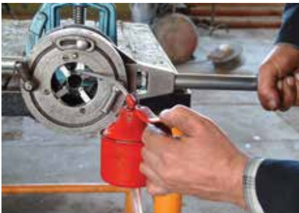
شکل ۴-۶۸- عمل روغن کاری در حین حدیده کاری
