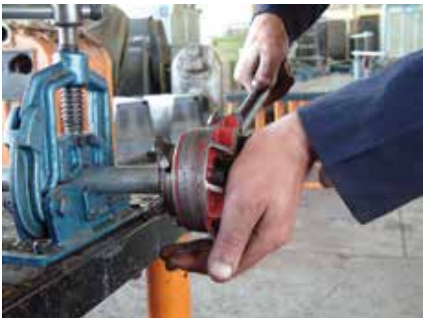
شکل ۴-۳۳- درگیر نمودن پارچه‌های حدیده با لوله
