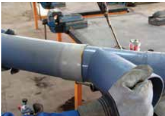
شکل ۲-۱۰- خارج کردن فیتینگ از سرکاسه
