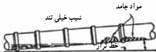
شکل ۱۱-۳ الف - نتیجه‌ی شیب زیاد لوله‌ی افقی فاضلاب
