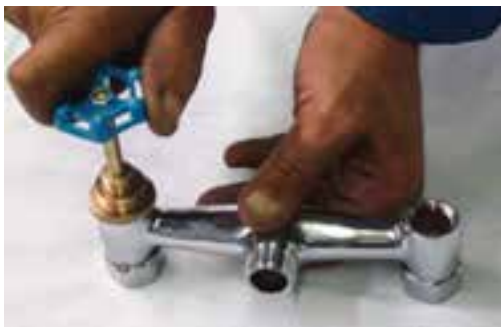
شکل ۲-۶۸- شیر تراش در حال کار شیر تراش
