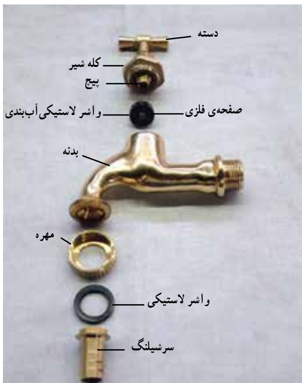
شکل ۱۲-۲- ب - اجزای شیر برنجی سرشیلنگی
