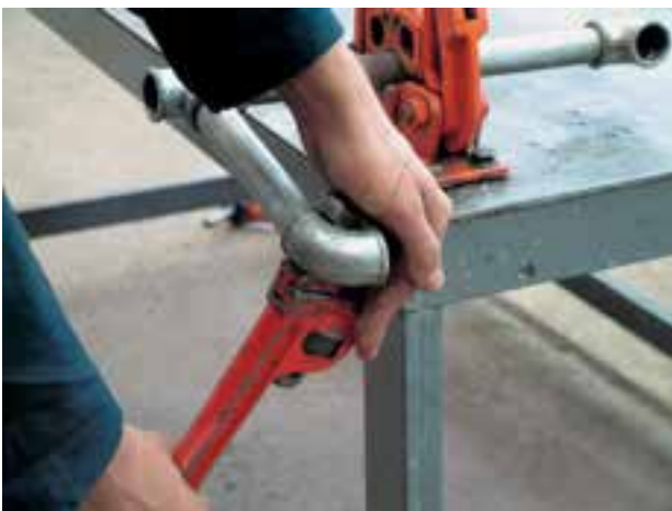
شکل ۱۰۵-۵- روش غلط سفت کردن مدار
