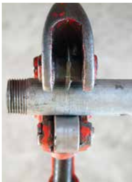
شکل ۹۶-۵- استفاده‌ی غلط از لوله‌بُر با تیغه‌ی شکسته
