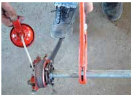
شکل ۱۲۱-۵- استفاده از روغن در جریان حدیده کاری
