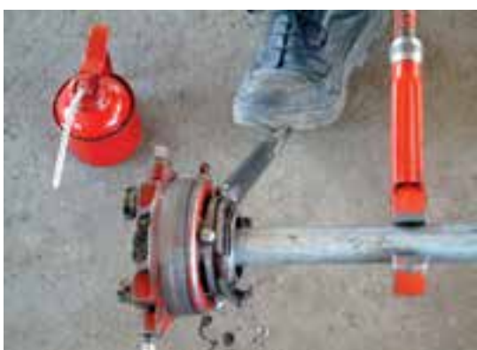
شکل ۱۲۳-۵- عمل باز کردن سردنده از پارچه‌های حدیده
