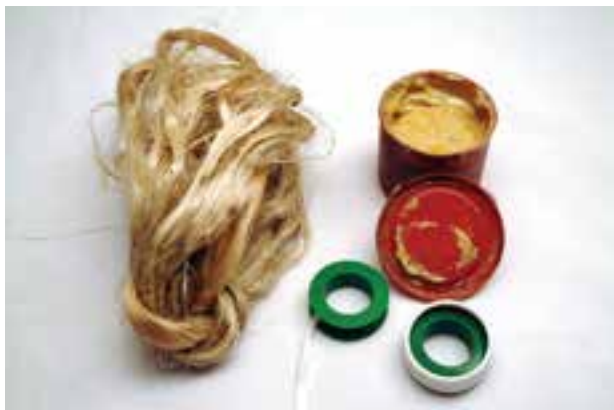
شکل ۴۸-۵- مواد آب بندی لوله کشی آب و فاضلاب
