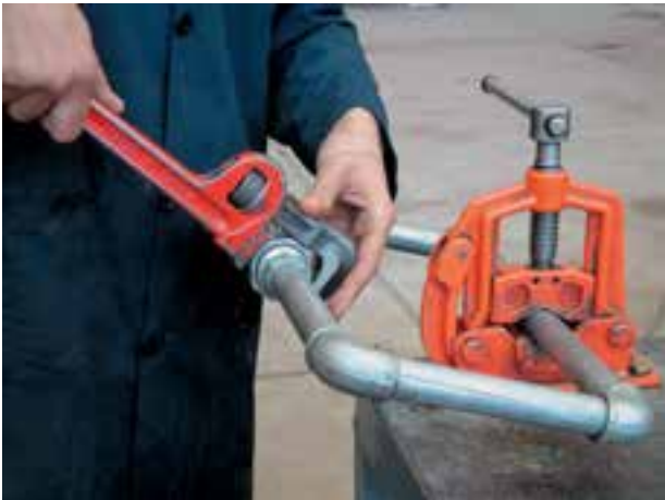
شکل ۵-۱۰۶- نحوه‌ی غلط سفت کردن مهره ماسوره
