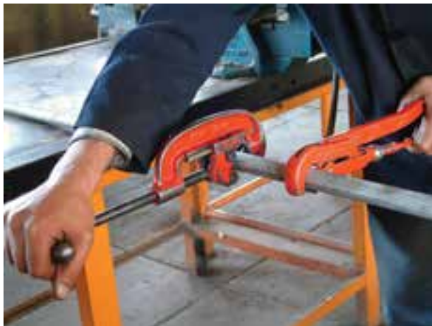
شکل ۱۱۶-۵- ادامه‌ی برش‌کاری لوله
