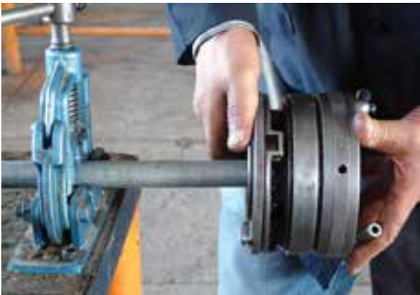
شکل ۵-۱۳۰- حدیده کردن لوله‌ها
