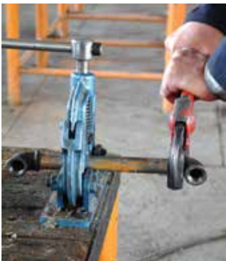
شکل ۵-۱۳۲- سفت کردن فیتینگ‌ها به لوله‌ها و تکمیل مدار باز
