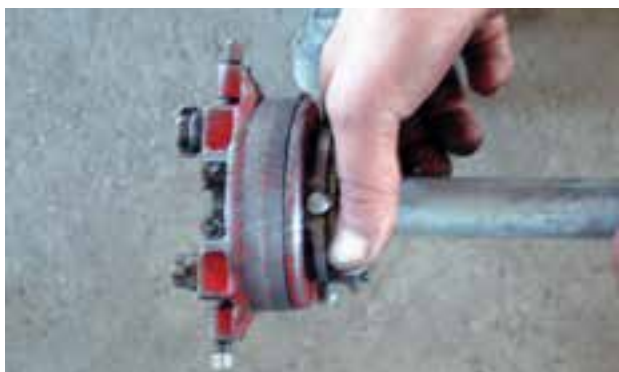
شکل ۱۲۴-۵- باز کردن فلکه‌ی چهار نظام حدیده
