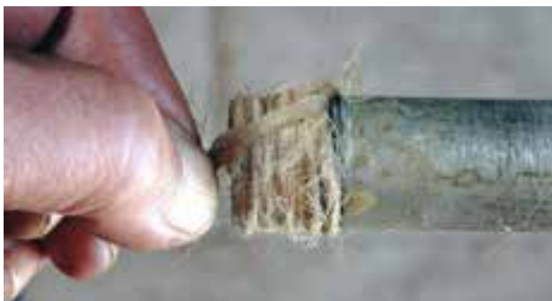
شکل ۵-۵۶- بریدن اضافی کنف به وسیله ی لبه ی تیز سردنده
