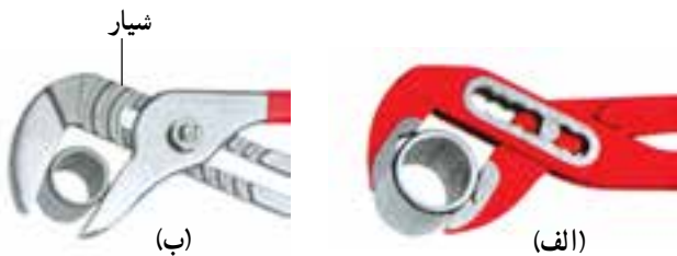
شکل ۷۰-۵- سوراخ ها و شیارهای متعدد آچارهای کلاغی
