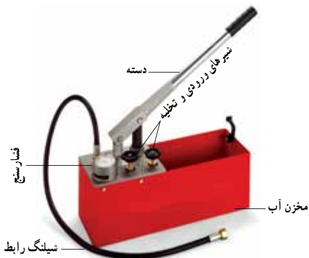
شکل ۸۷-۵- پمپ آزمایش دستی و اجزای آن
