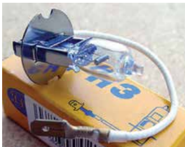
شکل ۱-۳۱- لامپ مورد استفاده در چراغ‌های مه‌شکن، نورافکن‌ها
