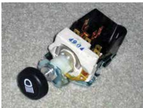
شکل ۱-۷۱- سوئیچ چراغ‌های روشنایی نوع چرخشی
