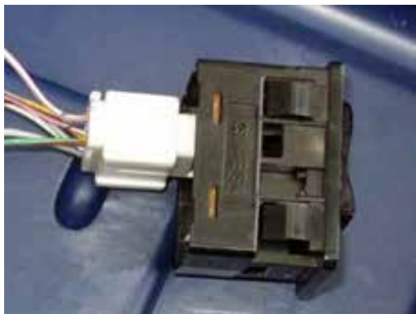
شکل ۱-۷۰- سوئیچ چراغ بزرگ جلو روی پانل
