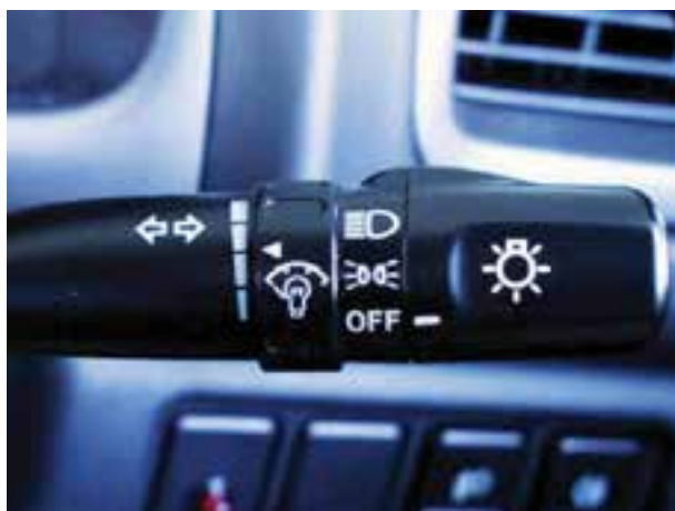
شکل ۱-۷۲- سوئیچ چراغ‌های روشنایی (طرح دسته‌ی راهنما)
