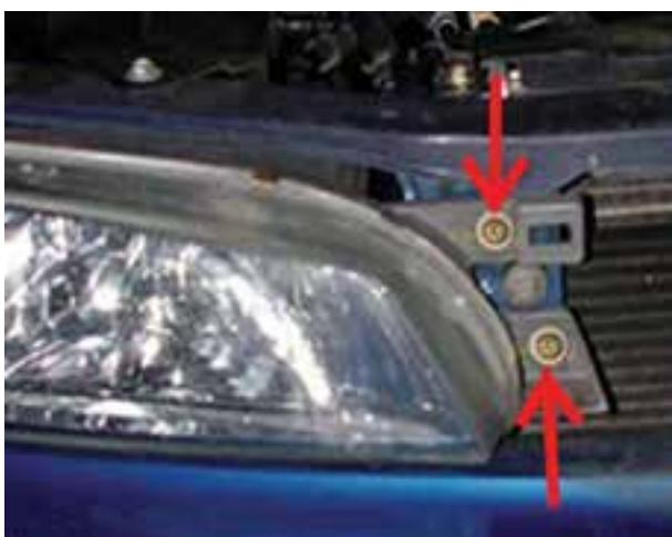
شکل ۱-۴۰- پیچ‌های نگه‌دارنده‌ی چراغ‌های بزرگ جلو
