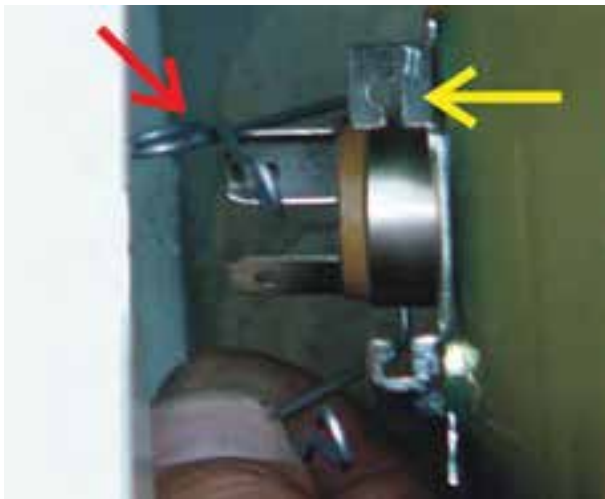
شکل ۴۴-۱- آزاد کردن میله‌ی فنری روی لامپ چراغ بزرگ جلوی خودرو
