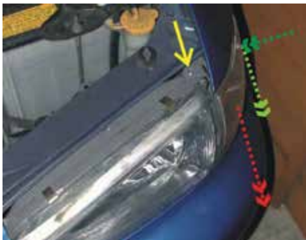
شکل ۱-۳۸- نحوه‌ی جداکردن چراغ جانبی روشنایی
