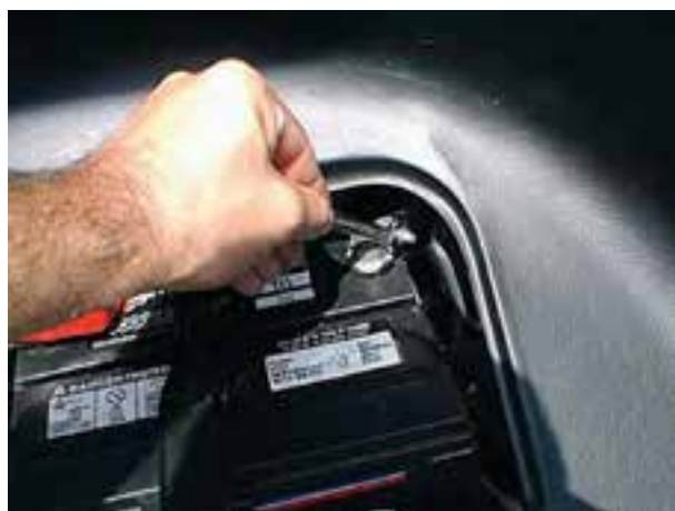
شکل ۱-۵۲- بازکردن بست ترمینال منفی باتری
