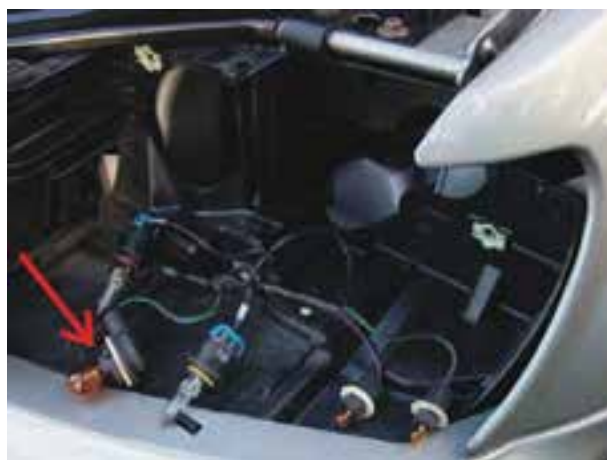
شکل ۱-۵۱- لامپ چراغ‌های روشنایی در یک نوع خودرو
