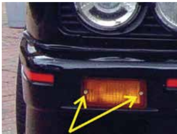
شکل ۱-۵۰- پیچ‌های اتصال تلق چراغ راهنما
