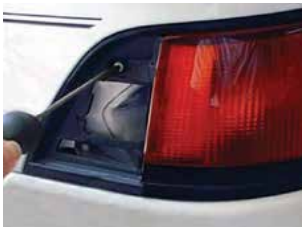
شکل ۱-۵۶- باز کردن پیچ‌های قاب چراغ
