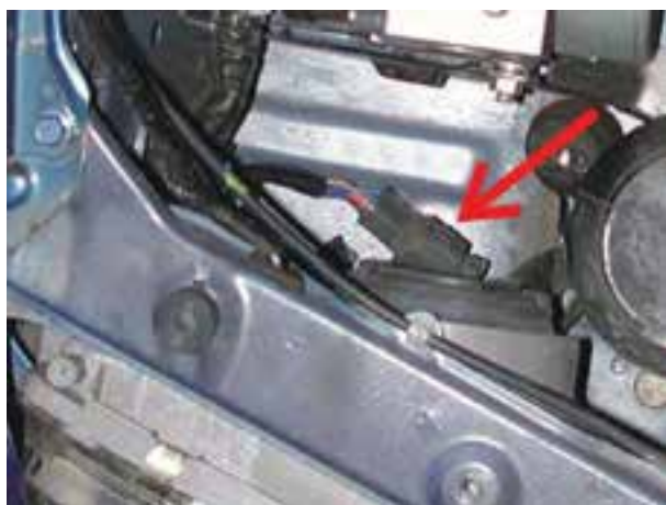
شکل ۳۷-۱- کاتوچویی اتصال سیم‌کشی چراغ‌های روشنایی
