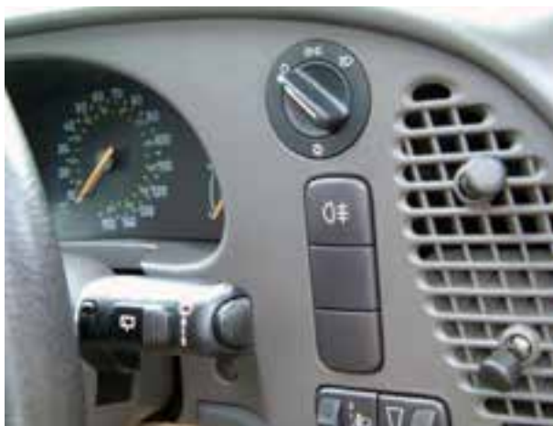
شکل ۱-۶۹- یک نوع سوئیچ روشنایی
