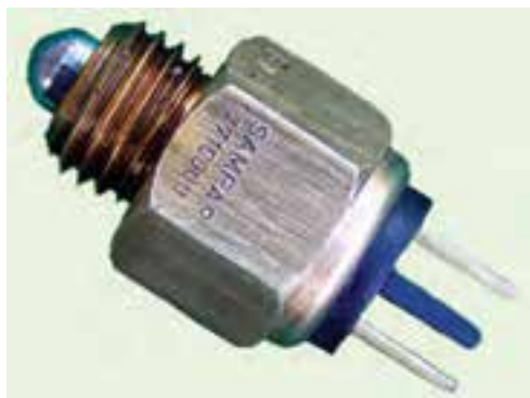
شکل ۱-۷۸- سوئیچ چراغ‌های دنده عقب
