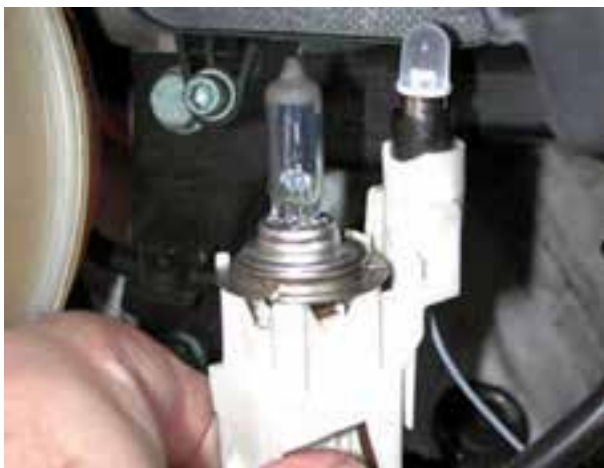
شکل ۱-۴۹ - پایه‌ی مشترک لامپ‌های چراغ روشنایی و پارک
