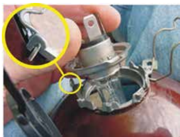
شکل ۱-۴۳- نحوه‌ی ثابت شدن لامپ درون کاسه‌ی چراغ
