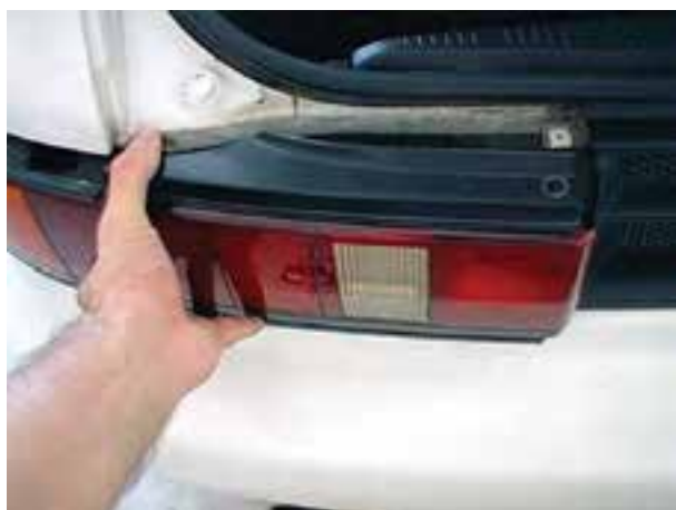
شکل ۱-۵۸- جدا کردن چراغ عقب از بدنه‌ی خودرو
