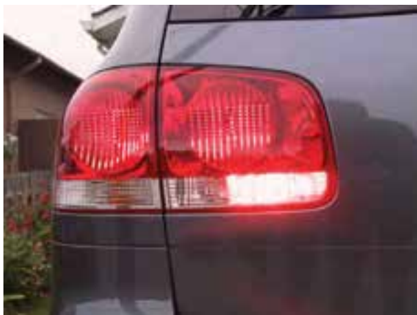
شکل ۱-۱۷- چراغ دنده عقب در وضعیت روشن
