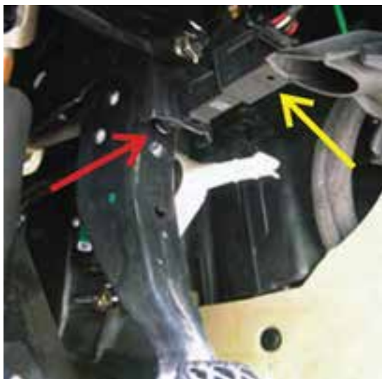
شکل ۱-۷۷- محل نصب سوئیچ مکانیکی ترمز
