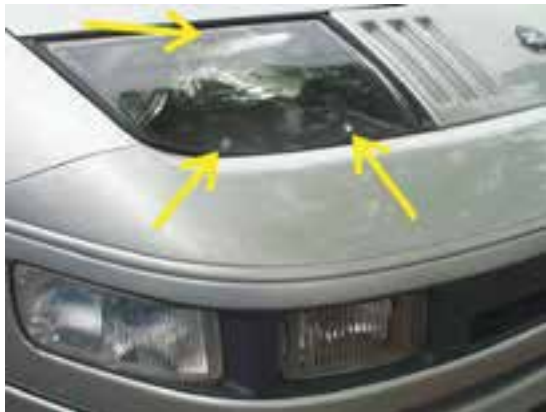
شکل ۱۵۹-۱- گودی‌های روی بلوری چراغ بزرگ یک نوع خودرو سواری
