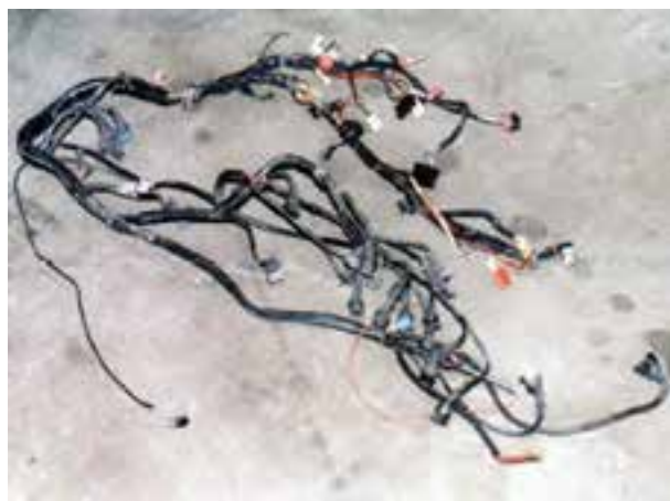
شکل ۱۳۳-۱- دسته‌ی سیم‌های یک نوع خودرو
