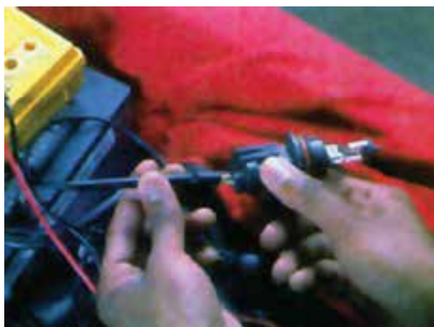
شکل ۱۴۲-۱- آزمایش لامپ چراغ‌های بزرگ جلو
