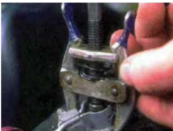
شکل ۱-۸۹- باز کردن بست اتصال بدنه‌ی باتری
