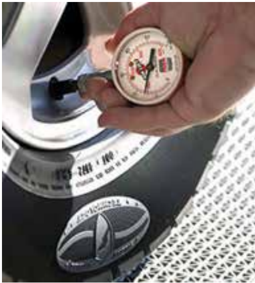
شکل ۱۵۸-۱- کنترل فشار باد تایر
