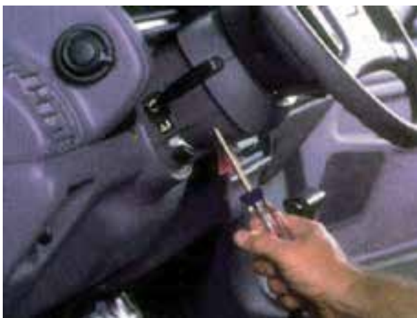
شکل ۱-۹۰- باز کردن پیچ‌های قاب سوئیچ روشنایی
