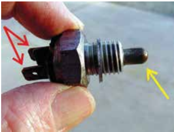
شکل ۱۰۴- پلانجر و ترمینال‌های سوئیچ دنده عقب
