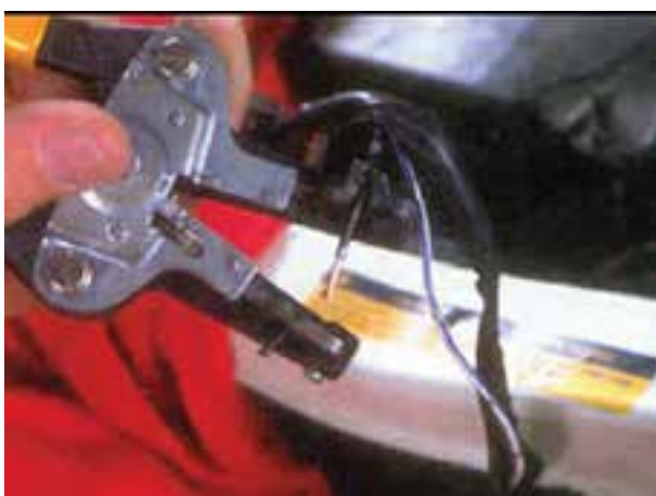
شکل ۱۴۷-۱- استفاده از ابزار سیم لخت کن
