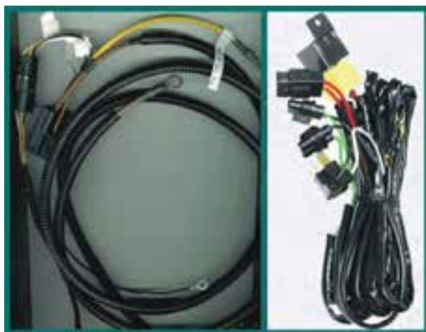
شکل ۱-۱۳۴- استفاده از لوله‌ی پی‌وی‌سی (PVC) لوله‌ی پلاستیکی در عایق‌کاری سیم‌های مدار الکتریکی
