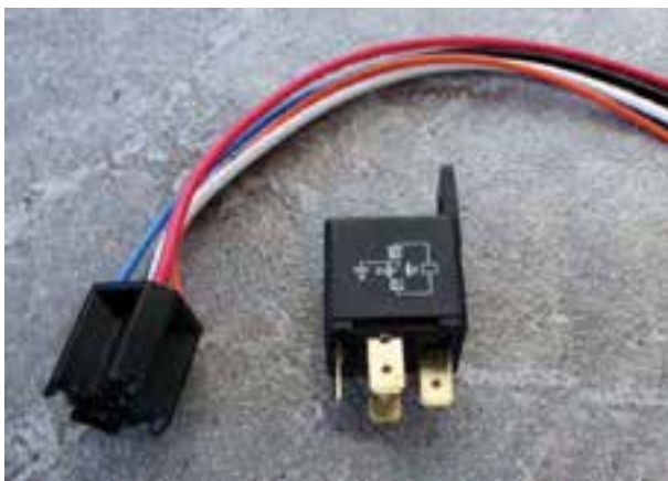
شکل ۱-۱۲۲- یک نوع آفتامات مدار الکتریکی خودرو
