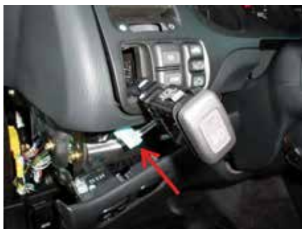
شکل ۱-۸۷- سوئیچ چراغ‌های بزرگ جلو
