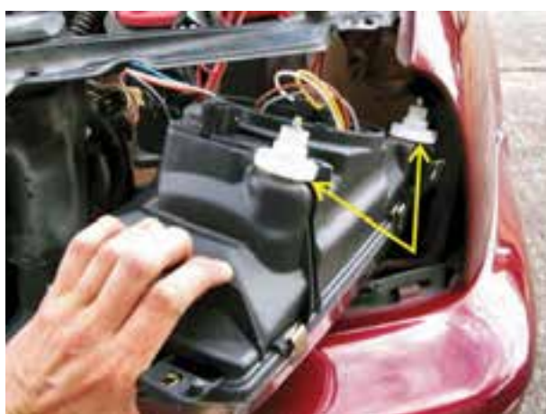
شکل ۱-۱۵۶- اهرم تنظیم کاسه چراغ یک نوع خودرو
