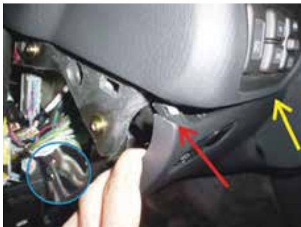
شکل ۱-۸۵- خارج کردن قاب از روی بدنه‌ی پانل
