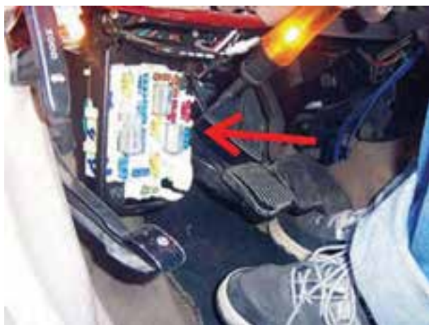
شکل ۱۲۰-۱- آزمایش جعبه‌ی فیوز با چراغ آزمایش
