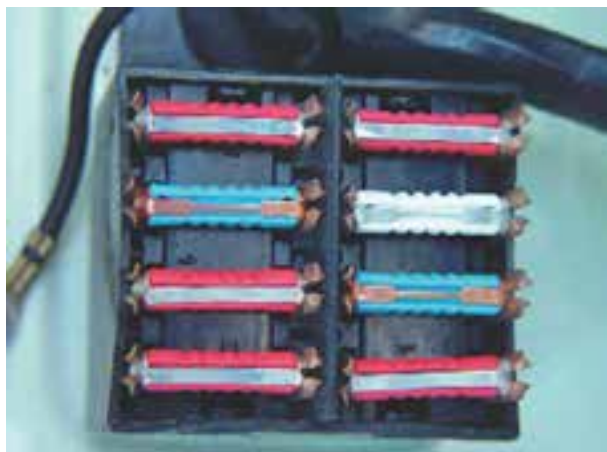
شکل ۱-۱۱۲- یک نوع جعبه‌ی فیوز مورد استفاده در خودرو
