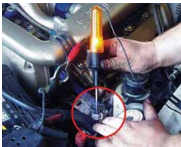
شکل ۱-۱۴۵- آزمایش برقراری جریان مدار چراغ‌های روشنایی
