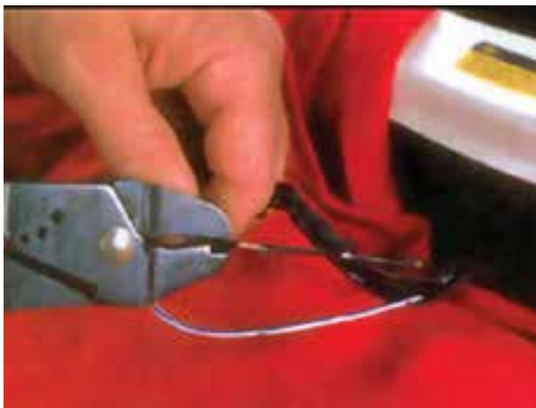
شکل ۱۴۶-۱- استفاده از انبر مخصوص برای قطع سیم
