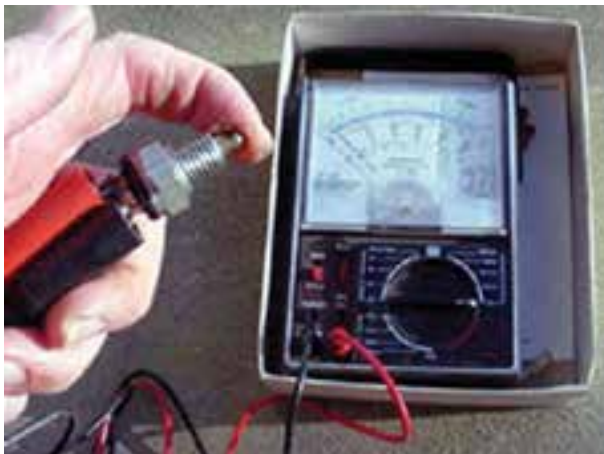
شکل ۱۰۵-۱- آزمایش سوئیچ چراغ‌های دنده عقب
