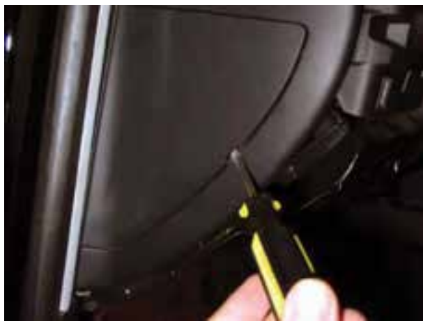
شکل ۱۱۸-۱- آزاد کردن خار پوشش محافظه‌ی جعبه‌ی فیوز
