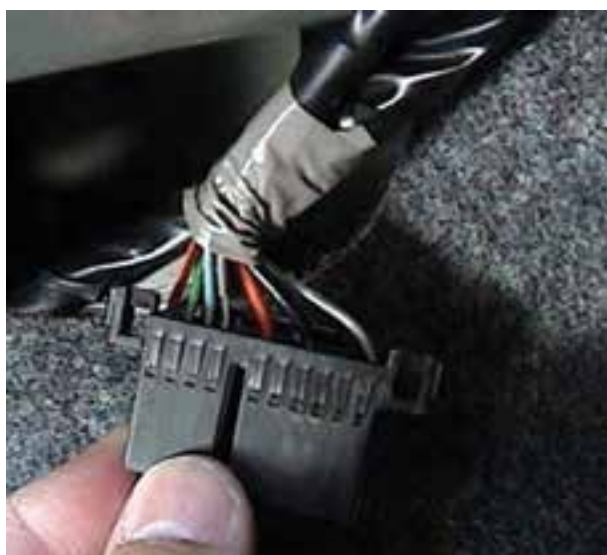
شکل ۱-۱۳۵- سوکت اتصال سیم‌کشی مدار به دستگاه الکتریکی
