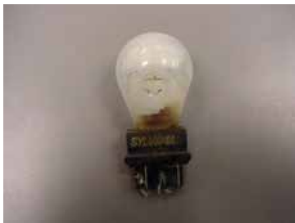
شکل ۱۴۱-۱- اثر عوامل فیزیکی در معیوب شدن لامپ
