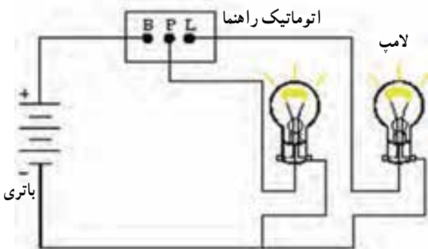
ب - آزمایش اتوماتیک راهنما (سه ترمینالی)
