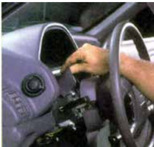
شکل ۹۱-۱- بیرون آوردن قاب سوئیچ روشنایی
