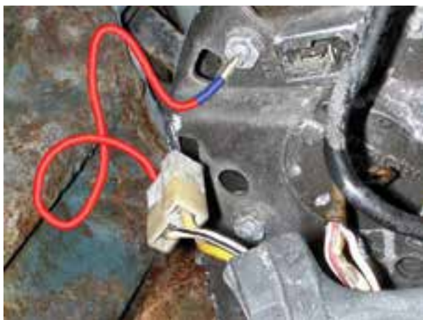
شکل ۳-۳۶- آزمایش مدار لامپ شارژ
