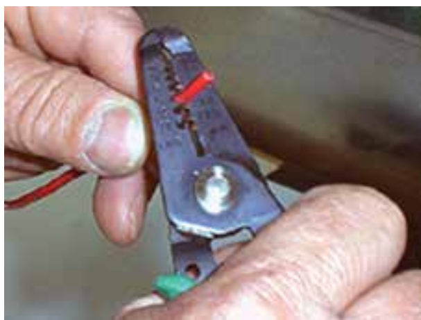
شکل ۳-۳۸- جدا کردن عایق سر سیم ها
