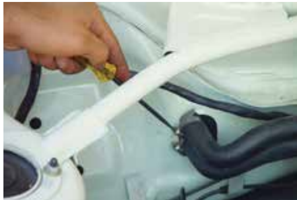
شکل ۴-۳۱- باز کردن لوله های آب رادیاتور بخاری
