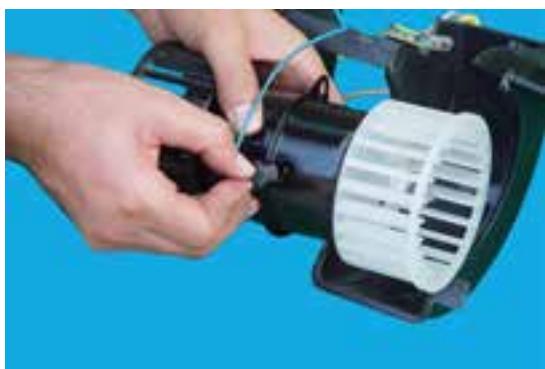
شکل ۴-۴۱- جدا کردن سیم از زغال‌ها
