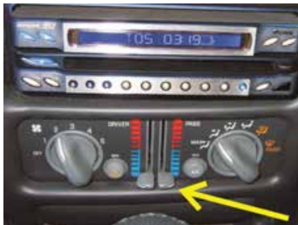
شکل ۴-۵۴- اهرم‌های تنظیم هوای ورودی
