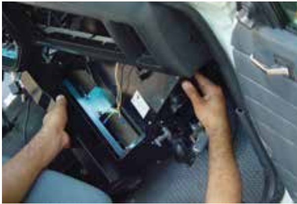
شکل ۳۴-۴- خارج کردن بخاری از محل نصب آب
