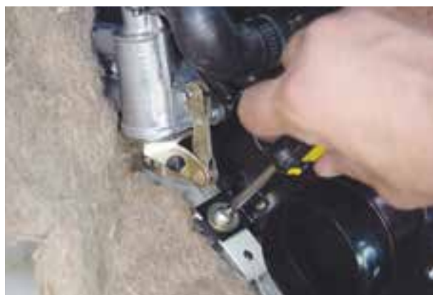
شکل ۴-۳۳- پیچ های پایه ی بخاری
