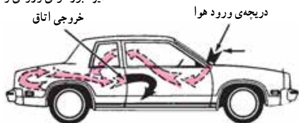
شکل ۴-۱۱- مسیر عبور جریان هوای گرم در خودرو
