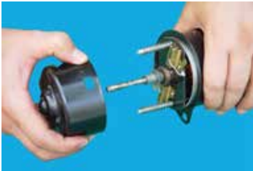
شکل ۴۵-۴ جدا کردن پوسته‌ی موتور
