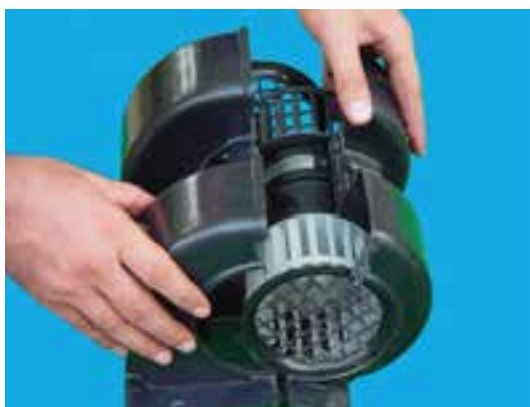
شکل ۴-۴۰ – جدا کردن محفظه‌ی نگهدارنده‌ی موتور
