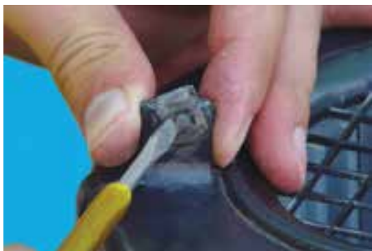
شکل ۴-۳۸ – باز کردن ضامن خار
