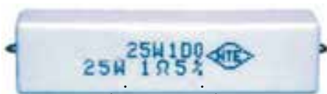
مقدار مقاومت یک اهم تولرانس ۵ درصد
