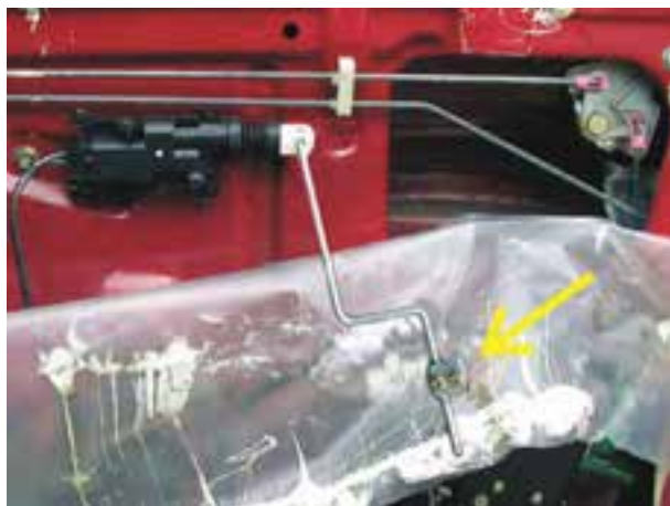
شکل ۳۰-۲ سوار کردن بست فلزی رابط در روی میله‌ی متصل به عملگر الکتریکی
