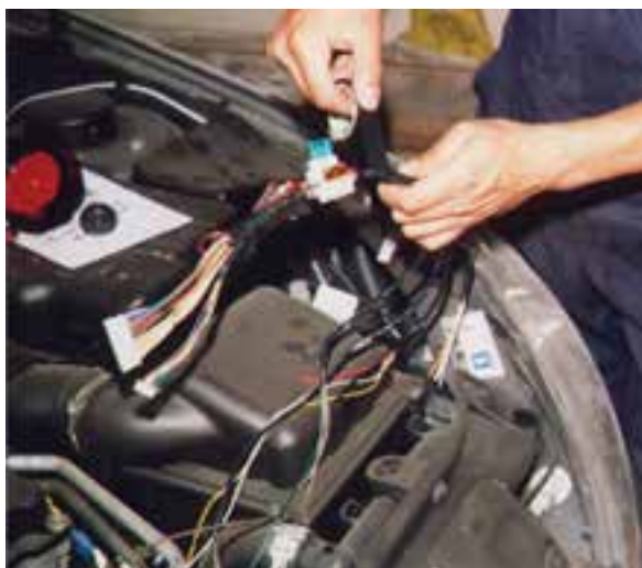
شکل ۲-۷۷- نحوه‌ی عایق‌بندی سیم‌های مدار الکتریکی دزدگیر
