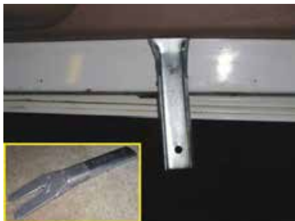
شکل ۲-۳۵- اهرم خاردرآر و نحوه‌ی استفاده از آن
