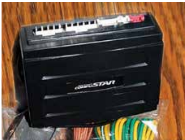
شکل ۵۷-۲- واحد اصلی سیستم دزدگیر
