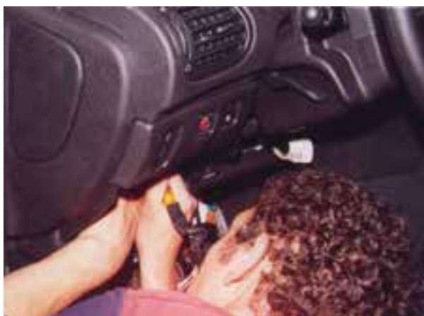
شکل ۲-۹۵ آزمایش برقراری جریان الکتریکی مدار
