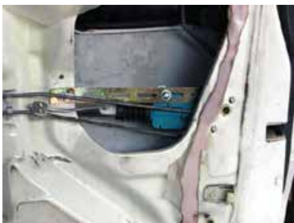
شکل ۳۷-۲- نحوه‌ی اتصال عملگر الکتریکی
