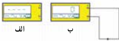
شکل ۲-۷۹ - آزمایش اطمینان از سلامت اهم متر
