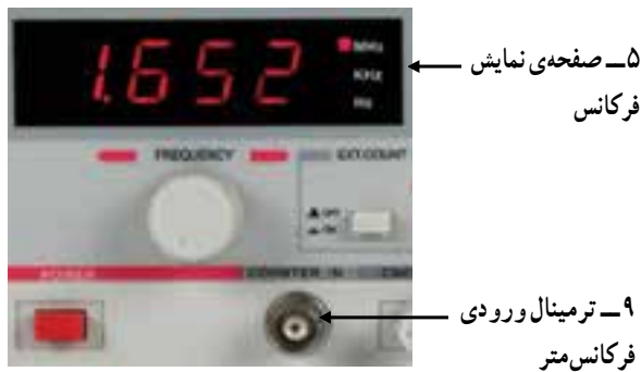
شکل ۱۰۳-۲ فرکانس متر و ترمینال ورودی آن
