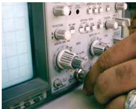
شکل ۱۱۴-۲ نحوه‌ی اتصال BNC به اسیلوسکوپ
