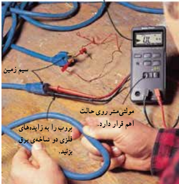
شکل ۲-۸۰ - آزمایش سیم رابط برق دستگاه.
