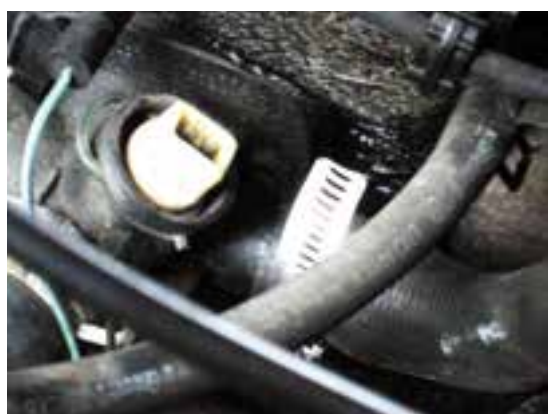
شکل ۲۵-۶- ترمینال‌های سنسور حرارتی مدار خنک‌کاری
