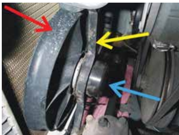
شکل ۱۸-۶- مکانیزم اهرم بندی فن
