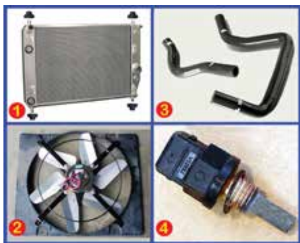
شکل ۲-۶- اجزای مدار خنک کاری
