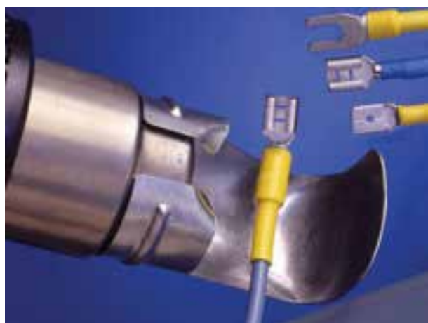
شکل ۶-۳۱- عایق کاری محل اتصال سیم و سرسیم
