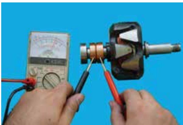
شکل ۷-۷۵ - آزمایش سالم بودن سیم پیچ روتور
