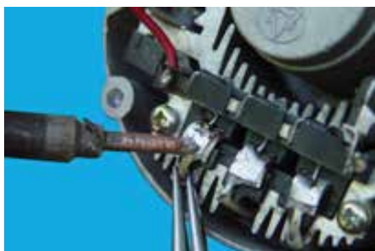
شکل ۵۶-۷- جدا کردن سیم‌های استاتور از یک‌سوکننده
