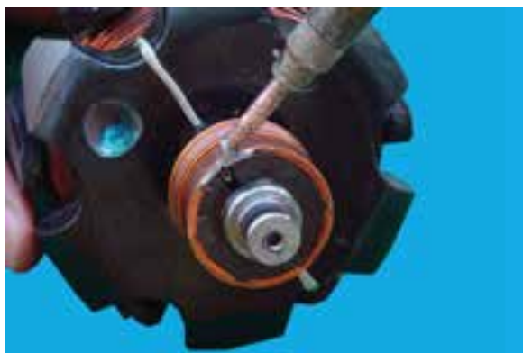
شکل ۶۶-۷ – جدا کردن سیم‌های روتور از کلکتور
