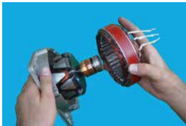
شکل ۶۲-۷ - جدا کردن استاتور
