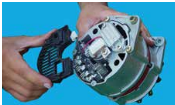
شکل ۵۲-۷- بازکردن درپوش دیودها
