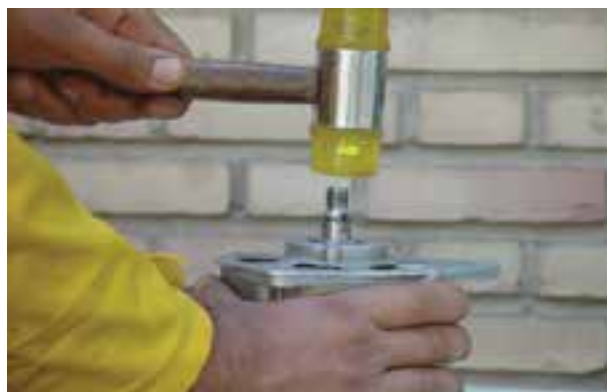
شکل ۶۳-۷ - بیرون آوردن روتور از درپوش
