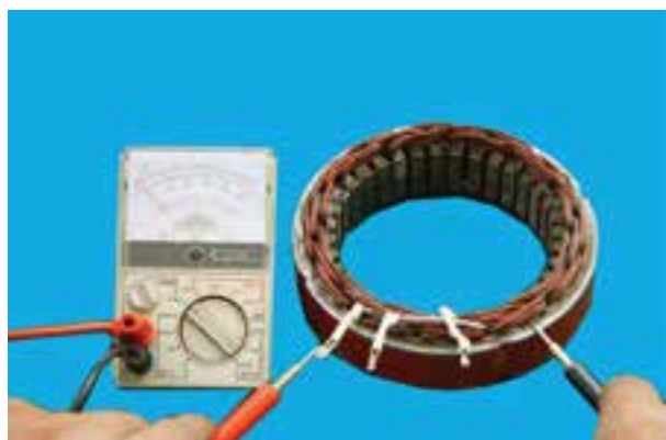
شکل ۷-۷۸ - آزمایش اتصال بدنه نبودن سیم پیچ استاتور
