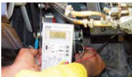
شکل ۷۲-۷ - اتصال ولت‌متر بین ترمینال B و بدنه
