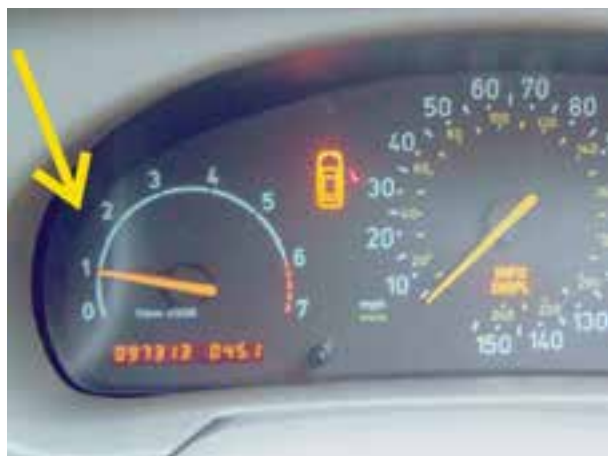
شکل ۷-۱۰۰- حالت دور آرام موتور
