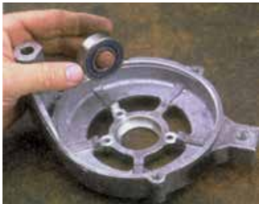
شکل ۷۰-۷ - خارج کردن بلبرینگ و آزمایش آن
