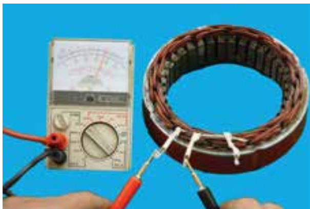
شکل ۷-۷۹ - آزمایش سالم بودن سیم پیچ استاتور
