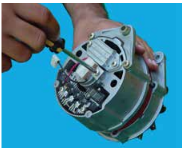
شکل ۵۳-۷- بازکردن پارازیت گیر
