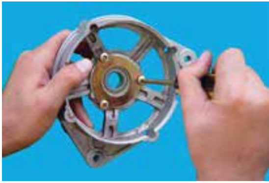
شکل ۶۷-۷ - باز کردن پیچ‌های نگه‌دارنده‌ی بلبرینگ
