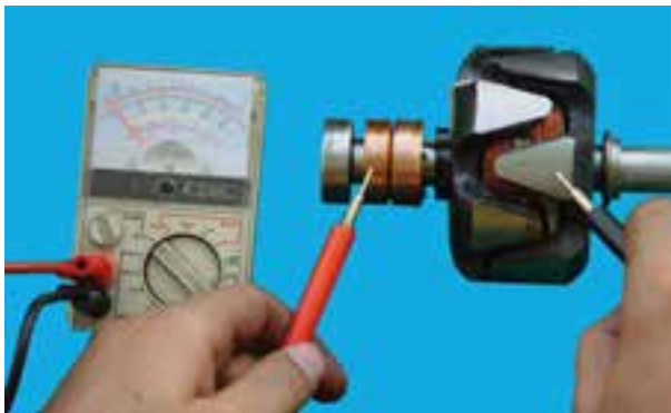
شکل ۷-۷۴ - آزمایش اتصال بدنه نبودن سیم پیچ روتور
