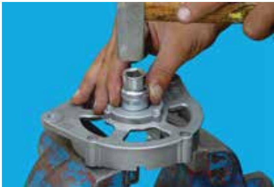
شکل ۶۹-۷ - بیرون آوردن بلبرینگ
