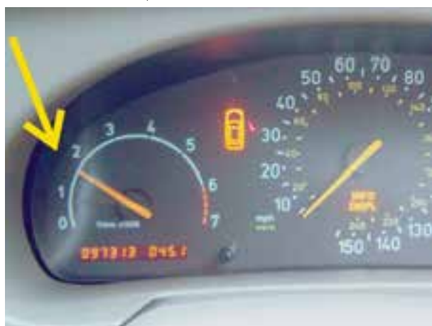
شکل ۷-۱۰۱- افزایش دور موتور برای آزمایش
