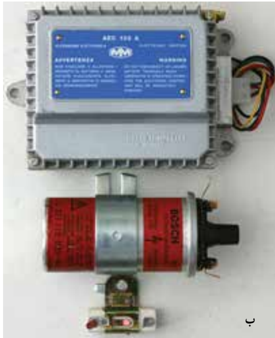
شکل ۱۴۶-۲- دو نمونه سیستم جرقه‌زنی قابل نصب روی انواع خودروها
