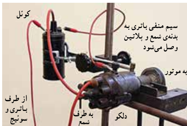
شکل ۱۴۴-۲- مدار شبیه‌سازی شده‌ی سیستم جرقه‌زنی
